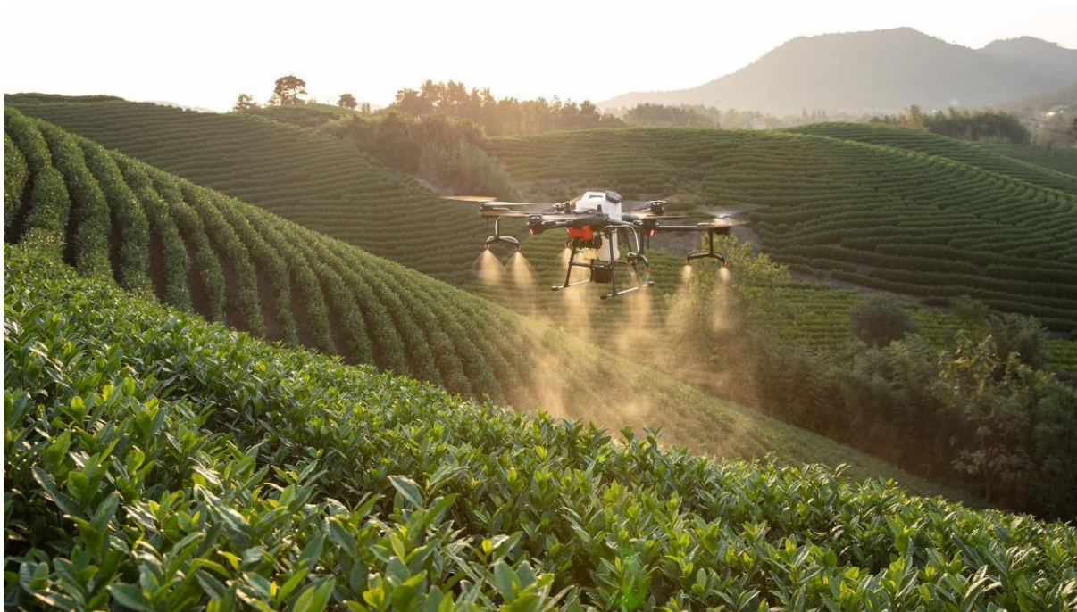
Rys. 2 Bezzałogowy statek powietrzny, dostosowany do aplikacji biopreparatu. Posiada zbiornik na żywe osobniki kruszynka zamknięte w kulach (źródło: pixabay)
