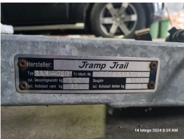
Foto nr 23 Łódź „ŁR-OIRM-6” w Biurze Terenowym GIRM w Szczecinie (tabliczka znamionowa przyczepy podłodziowej)
