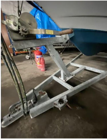
Foto nr 25 Łódź „ŁR-OIRM-6” w Biurze Terenowym GIRM w Szczecinie (wyciągarka łodzi na przyczepie podłodziowej)
