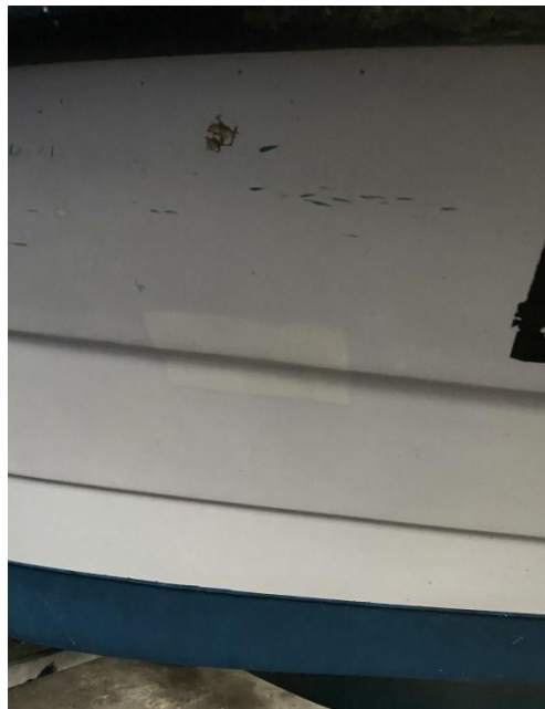
Foto nr 27 Łódź „ŁR-OIRM-6” w Biurze Terenowym GIRM w Szczecinie (widoczne uszkodzenia burty i prowizoryczne naprawy)
