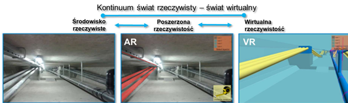
Rys. 4.2.2. Poszerzona rzeczywistość na przykładzie wnętrza dźwigara skrzynkowego mostu betonowego
