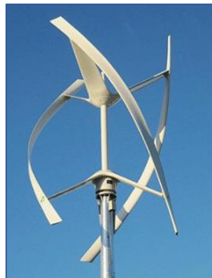
fot. 5 instsani: turbina Darrieusa typu helix (o osi pionowej)
