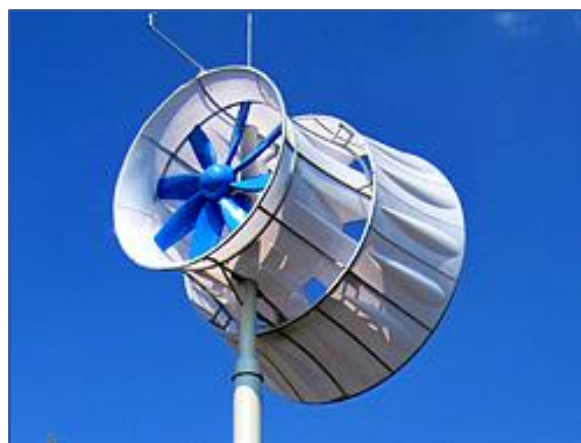
fot. 1 Magnus Larsen: turbina wiatrowa o osi poziomej z dyfuzorem
