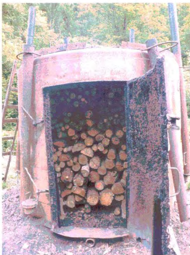
Rys. 1. Sposób załadunku retorty polowej, przestawnej o pojemności 8 m 3 - Punkt Wypału Węgla Drzewnego w Dołżycy, gm. Cisna; stan z dnia 16 czerwca 2014 r. [4]
