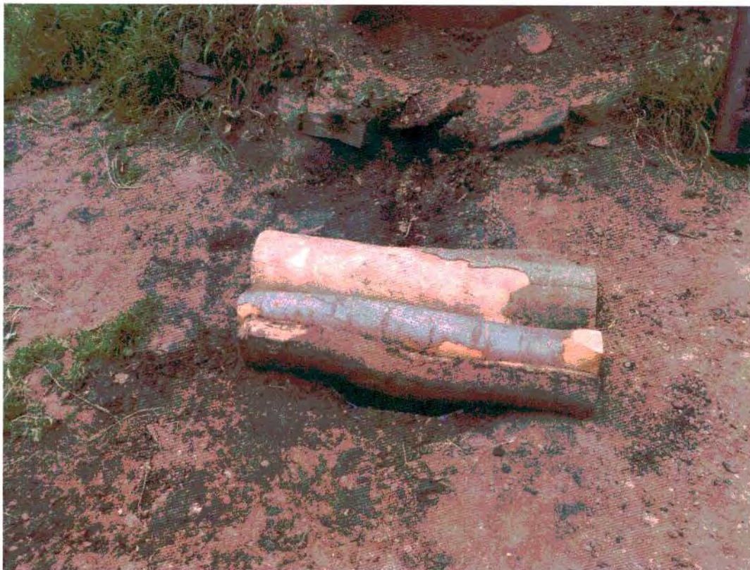
Rys. 3. Sposób zainstalowania w ziemi beczek metalowych na odcieki z retort na terenie Punktu Wypału Węgla Drzewnego w miejscowości Kolonice, gm. Baligród; stan z dnia 19 maja 2014 r. [4]
