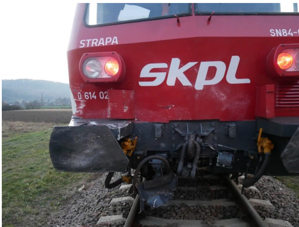
Fot. 3. Uszkodzony skład kabina "B" SN84-002 po zdarzeniu
