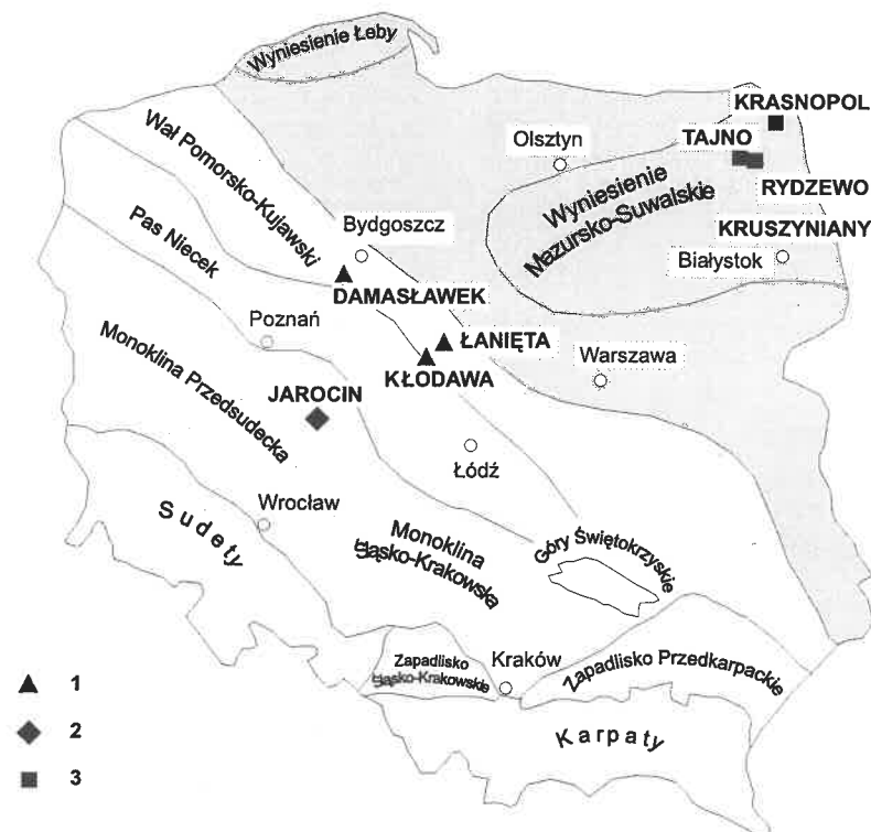
Rys. 2. Lokalizacja miejsc wytypowanych jako perspektywiczne dla budowy głębokiego składowiska odpadów promieniotwórczych na tle głównych jednostek geologicznych w Polsce 1 – wysady soli kamiennej; 2 – kompleks skał ilastych; 3 – skały magmowe (granity i inne)
