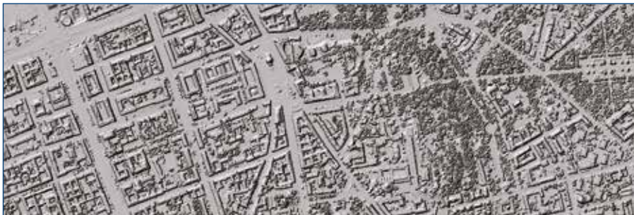
Rysunek 95. Ilustracja numerycznego modelu pokrycia terenu
