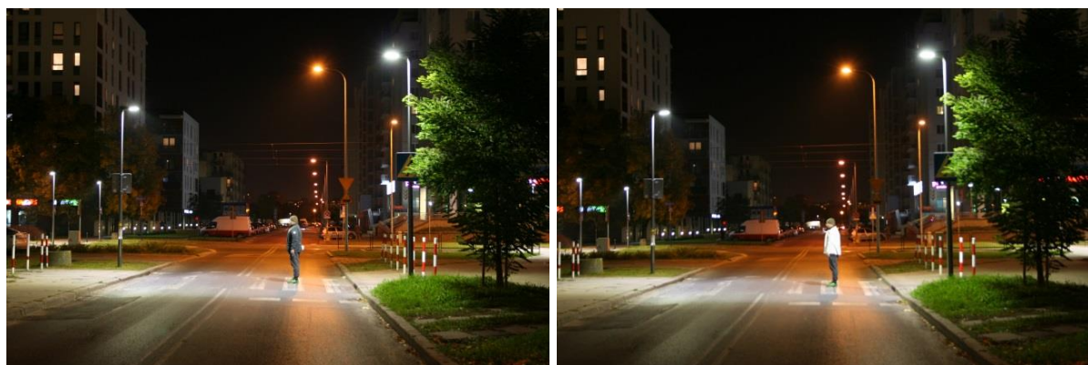
Rys. 7.2 Oświetlenie przejścia dla pieszych w kontraście dodatnim
