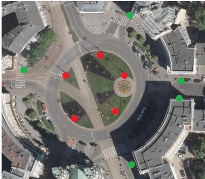
Rys. 3.65 Oświetlenie masztowe na skrzyżowaniu z ruchem okrężnym – zdjęcie lotnicze z oznaczonymi oświetleniem masztowym
