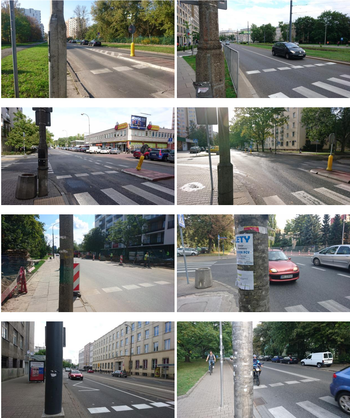
Rys. 6.3 Przykłady słupów ograniczających widoczność przy przejściach dla pieszych – perspektywa pieszego
