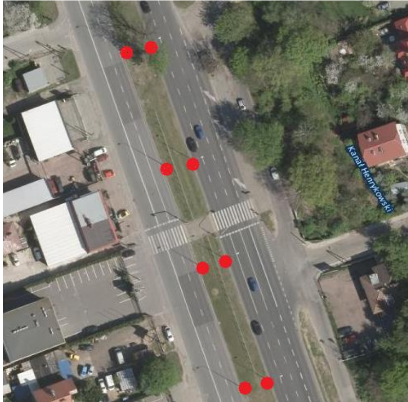
Rys. 3.56 System dwurzędowych latarni umieszczonych w pasie dzielącym przy lewych krawężniach jezdni. Przejście dla pieszych poza skrzyżowaniem
