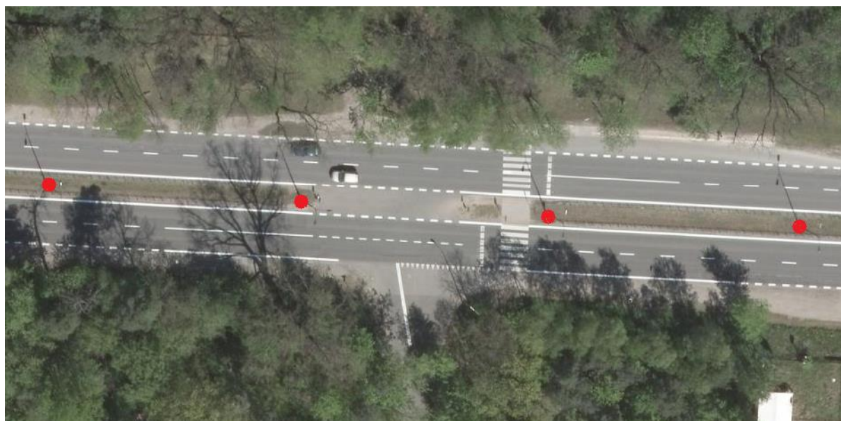
Rys. 3.73 Latarnie umieszczone w pasie dzielącym o szerokości mniejszej niż 6,0 m. Zdjęcie lotnicze z oznaczonymi słupami
