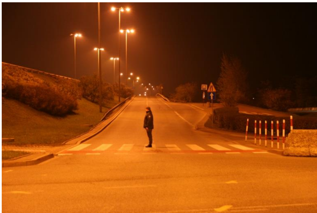
Rys. 7.1 Oświetlenie przejścia dla pieszych w kontraście ujemnym
