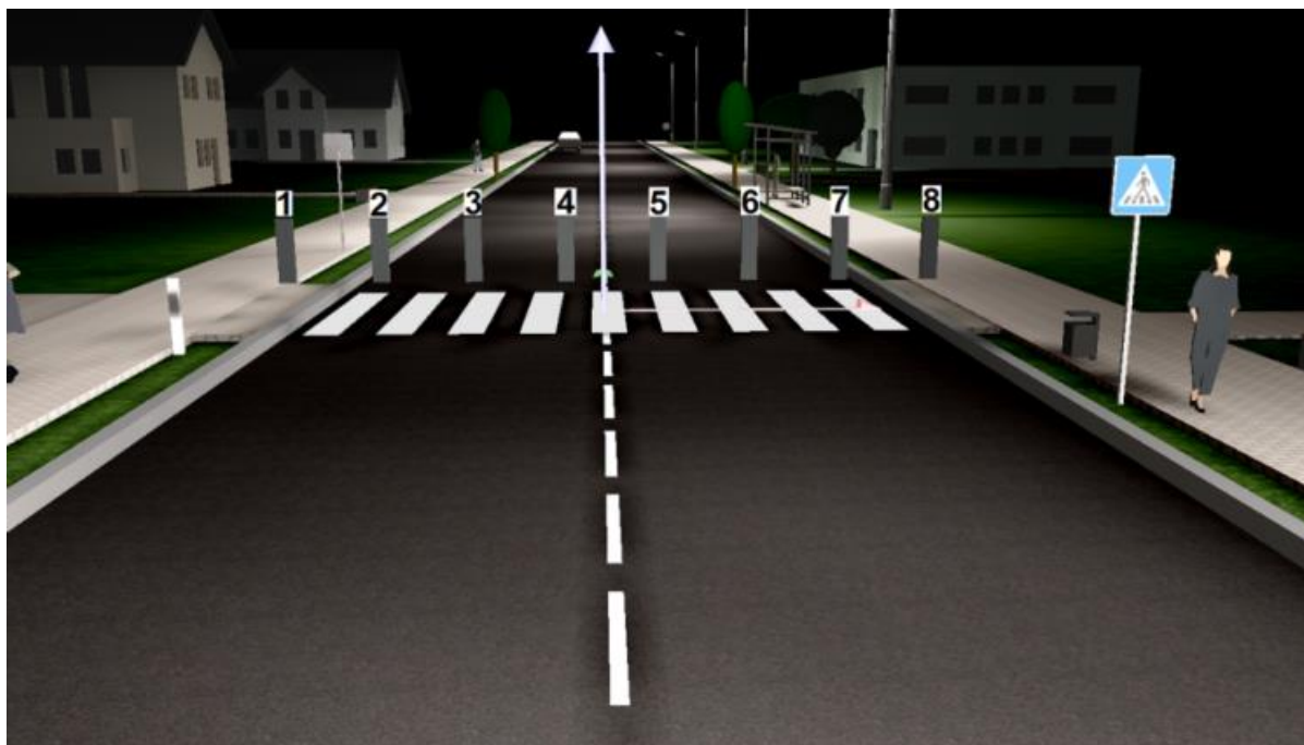
Rys. 3.35 Ustawienie obiektu testowego na przejściu dla pieszych
