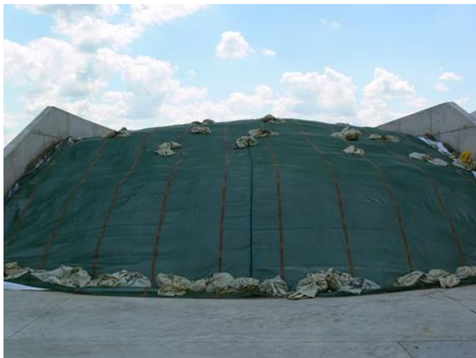
Fotografia 6. Sposób przykrycia kieszonki w silosie przejazdowym
