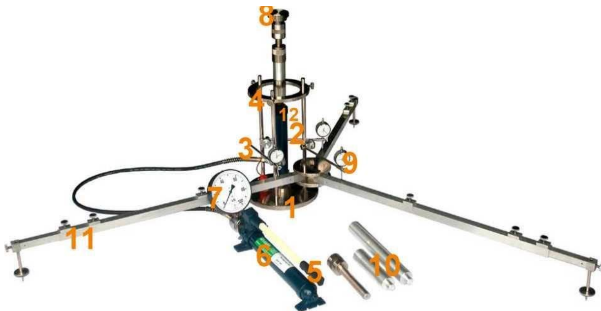
Rys. 1.1. Aparatura VSS z trzypunktowym pomiarem przemieszczenia płyty
