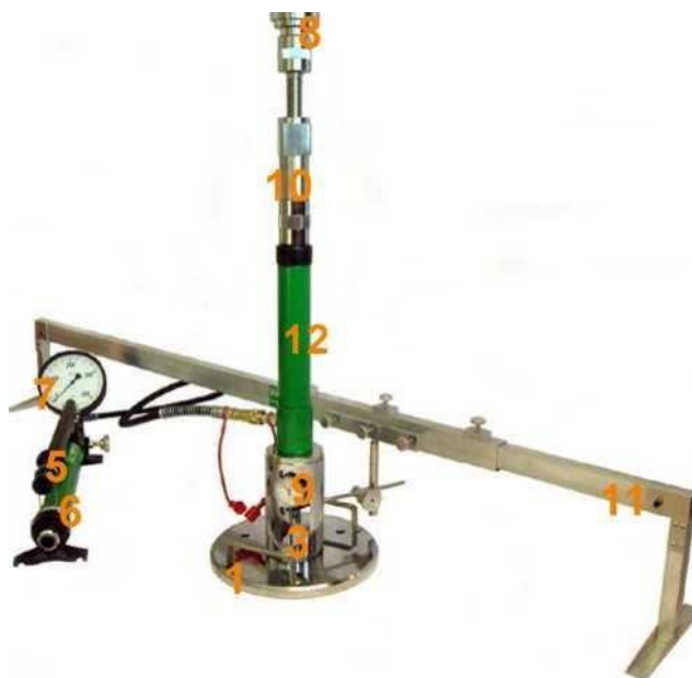
Rys. 1.2 Aparatura VSS z jednopunktowym pomiarem przemieszczenia płyty
