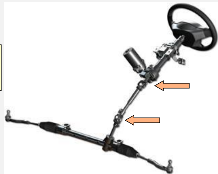
Układ kierowniczy samochodu osobowego z przekładnią zębatkową i wspomaganiem silnikiem elektrycznym
