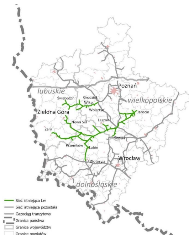
Rysunek 9. System przesyłowy gazu ziemnego zaazotowanego
