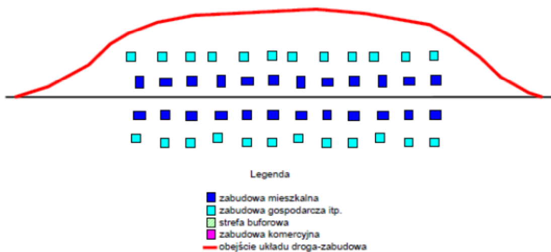
Rys. 7.112. Przykład zabudowy rozmieszczonej wzdłuż drogi
