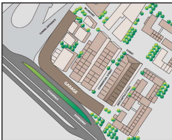
Rys. 7.8. Modelowy przykład zabudowy z garażami pełniącymi funkcję ekranującą [14]
