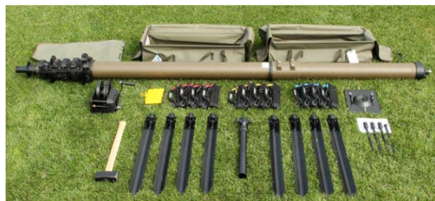
Fot. 17 Przenośny przemiennik radiowy oraz maszt składany na wyposażeniu SDŁ.
