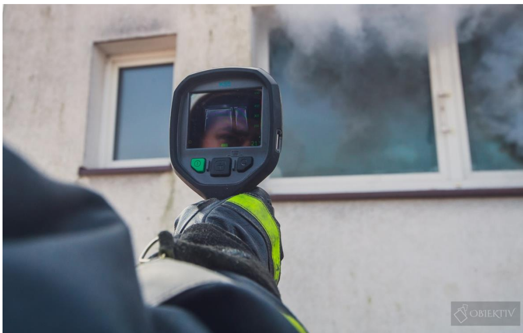
Fot. 32: Rozpoznanie otworów okiennych przy wsparciu kamerą termowizyjną. Widoczny obszar o podwyższonej temperaturze i nagrzanie górnej części framugi okna. W pokazanym przypadku informację z kamery termowizyjnej można zestawzić z widocznym dymem. Gdy zadymienie nie wydostaje się przez nieszczelności, obraz z termowizji może być jedynym źródłem informacji o podwyższonej temperaturze w danym pomieszczeniu w ramach wstępnego rozpoznania 360°. (fot. Piotr Zwarycz, obiektyw.com)
