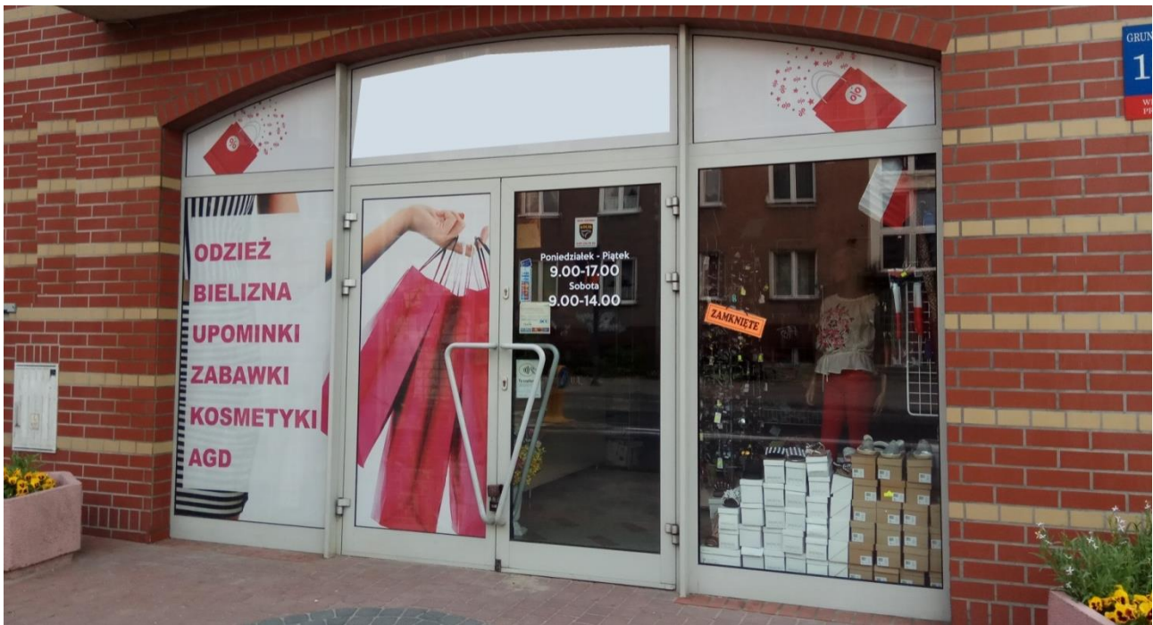
Fot. 30: Rozpoznanie pod kątem możliwego scenariusza rozwoju pożaru: lokal z tekstyliami różnego asortymentu. Powierzchnia przeszklona około 10m 2 – możliwy rozwój pożaru o mocy do 30MW.
