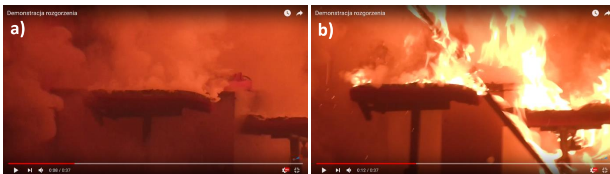
Fot. 45 a-b: Emitowany przez paliwa stałe „biały dym” to w rzeczywistości niespalone produkty rozkładu termicznego i/lub pirolizy, bogate w palne węglowodory. Są niezwykle podatne na zapłon i spalają się z wydzielaniem dużych ilości energii cieplnej. 28
