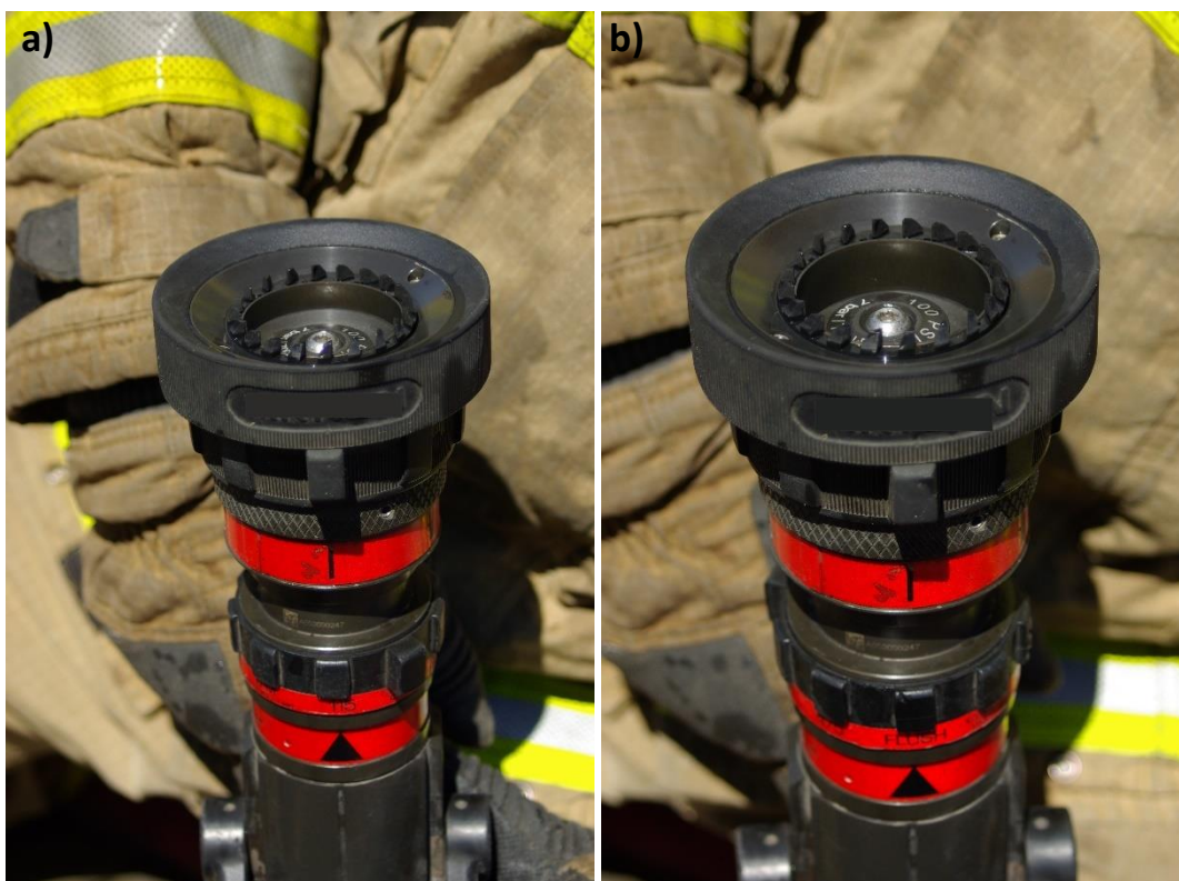
Fot. 70 a-b: Po lewej: prądownica ustawiona na przepływ 115 L/min i prąd zwarty. Po prawej: prądownica ustawiona na funkcję przepłukania („flush”) i prąd zwarty. Przeszczanie się trzpienia zmienia łączną powierzchnię wylotu dla podawanej wody (widoczną pod elementem z nacechowanym ciśnieniem roboczym prądownicy w barach oraz jednostkach PSI), co działa niezależnie od pierścienia regulującego kształt wydostającego się strumienia wody. [86]
