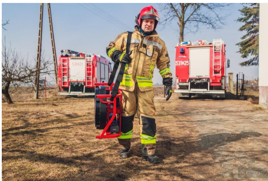
Fot. 163: Dzisiejsze wentylatory akumulatorowe charakteryzują się niewielką wagą, co podnosi ich uniwersalność. Łatwe wyjęcie ze skrytki oraz transport, a także brak zakłóceń pracy w zadymieniu czyni tego typu rozwiązania techniczne niezwykle atrakcyjnymi zamiennikami wentylatorów spalinowych. Nadal jednak jednostki napędzane elektrycznie ustępują jednostkom spalinowym pod względem wydajności, niemniej widać w ostatnich latach wyraźny trend poprawy tego parametru pracy. Wypada przyglądać się temu zjawisku, bowiem przy utrzymaniu trendu wentylatory akumulatorowe mogą kiedyś wyprzeć jednostki spalinowe. (fot. Piotr Zwarycz, Obiektiv.com)
