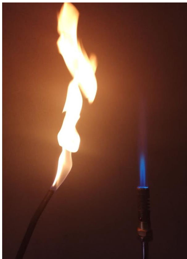
Fot. 11: Porównanie płomienia turbulentnego (po lewej) i laminarnego (po prawej) uzyskanych w wyniku spalania gazu LPG. Gaz po lewej stronie wydobywa się z dyszy a następnie miesza, co wprowadza turbulencje (spalanie dyfuzyjne). Gaz po prawej stronie wydobywa się z dyszy po wstępnym wymieszaniu z powietrzem, stąd jego laminarny przebieg i widocznie wyższa temperatura (niebieska barwa) towarzyszące spalaniu kinetycznemu.
