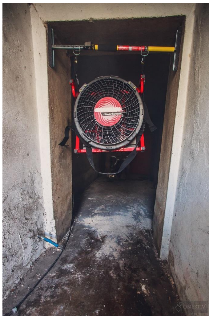
Fot. 165: Praca wentylatora wyciągowego przy usuwaniu dymu z piwnicy poprzez podwieszenie w drzwiach przy użyciu specjalnego drążka rozporowego, podobnego do tego, który stosowany jest w kurtynach dymowych. (fot. Piotr Zwarycz, Obiektiv.com)
