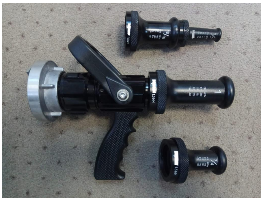
Fot. 86: Inna prądownice typu smoothbore: odkręcana rączka (uchwyt pistoletowy) oraz wymienne puszki o różnych średnicach (od ½ cala do 1 cala) i charakterystykach wypływu, w tym puszki kaskadowe.
