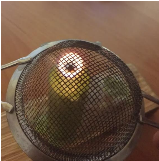
Fot. 7: Nakrywając płomień od góry sitkiem wykonanym z niepalnego materiału i likwidując tym samym górną część płomienia można zaobserwować pustą przestrzeń wewnątrz płomienia oraz strefę reakcji wokół tej przestrzeni.
