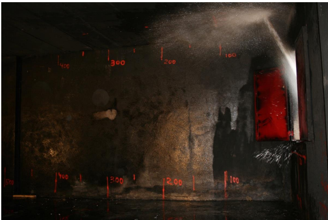
Fot. 143: Natarcie zewnętrzne, wariant B z rys. 90. Podanie wody z mniejszej odległości od fasady powoduje rozbicie strumienia i bardziej intensywne zraszanie powierzchni poniżej. [115, 116, 117]
