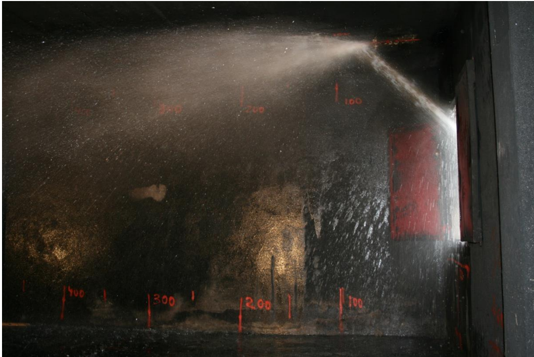
Fot. 142: Natarcie zewnętrzne, wariant A z rys. 90. Podanie wody z większej odległości od fasady powoduje przyleganie strumienia do sufitu i mniej intensywne zraszanie powierzchni poniżej. [115, 116, 117]
