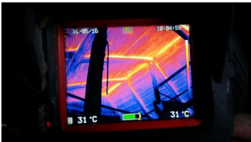
Fot. 62: Jak wspomniano w tekście, możliwość skorzystania z kamery termowizyjnej zapewni najskuteczniejsze wykrycie obecności ciepła. (fot. KP PSP w Starachowicach)
