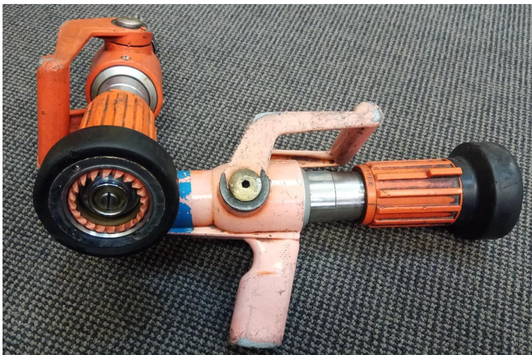
Fot. 66: Oryginalna prądownica TA FogFighter – pierwsza na świecie prądownica zaprojektowana pod koniec lat 70-tych jako narzędzie dedykowane do chłodzenia gazów pożarowych . Po lewej wersja bez uchwytu pistoletowego, po prawej z uchwytem. Prądownica była wyposażona w wirujący pierścień mgłowy. Wśród postawionych przez pomysłodawców wymagań, które spełniała, była prosta konstrukcja, skupiony prąd zwarty, regulowana wydajność, regulowany kat rozproszenia, możliwość przepłukania i odpowiednia wielkość kropli. [93, 94]
