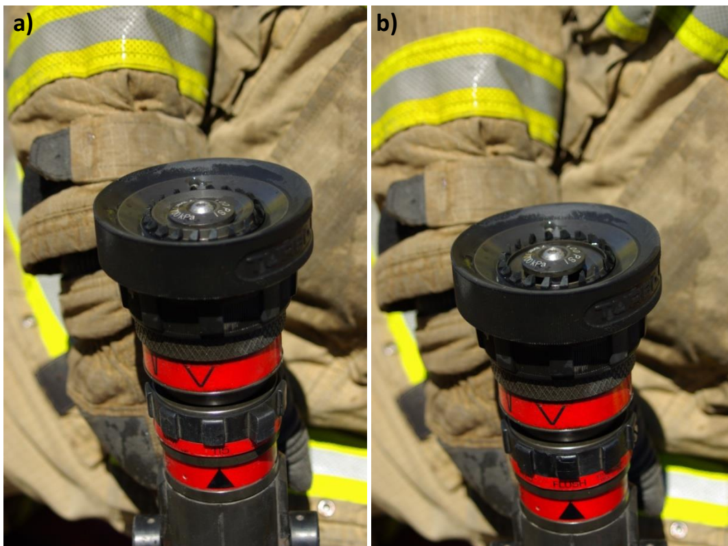
Fot. 69 a-b: Po lewej: prądownica ustawiona na przepływ 115 L/min i prąd rozproszony. Po prawej: prądownica ustawiona na funkcję przepłukania („flush”) i prąd rozproszony. Przemieszczanie się trzpienia zmienia łączną powierzchnię wylotu dla podawanej wody (widoczną pod elementem z nacechowanym ciśnieniem roboczym prądownicy w barach oraz jednostkach PSI), co działa niezależnie od pierścienia regulującego kształt wydostającego się strumienia wody. [86]
