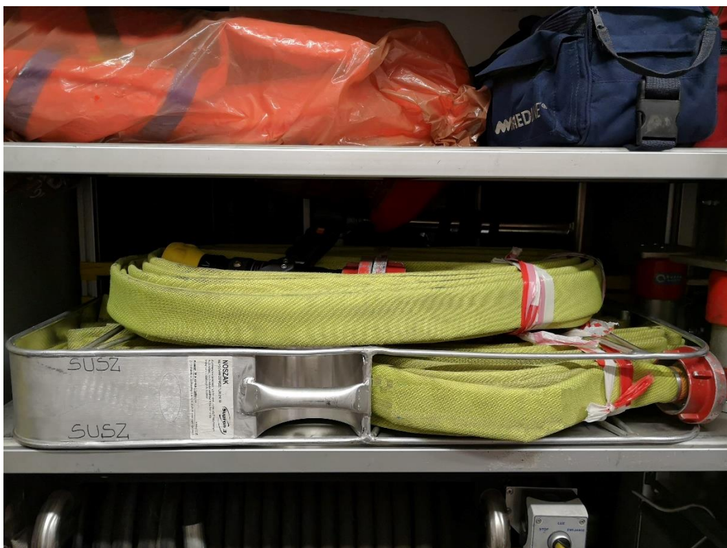
Fot. 94: Odcinki węzowe przygotowane do szybkiego sprawienia przewożone w skrytce samochodu gaśniczego: kaseton z węzami zwiniętymi w harmonijkę oraz pakiet węzowy „Cleveland Lay”, zwany potocznie „ślimakiem” z prądownicą. Odcinki związane są fragmentami taśmy do oznaczania terenu akcji. (fot.: Arkadiusz Frankiewicz)
