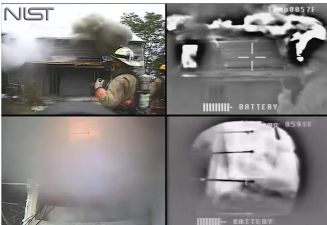
Fot. 140: Badania NIST nad efektem podania prądów gaśniczych przez okno do palącego się pomieszczenia. Niespełna 5 sekund po podaniu prądu rozproszonego widać, że wewnątrz nastąpił znaczny ruch gazów pożarowych. Taki efekt mógłby spowodować znaczne zagrożenie dla osób znajdujących się w pomieszczeniach sąsiadujących z pożarem lub na klatce schodowej. Dzięki uprzejmości NIST 49
