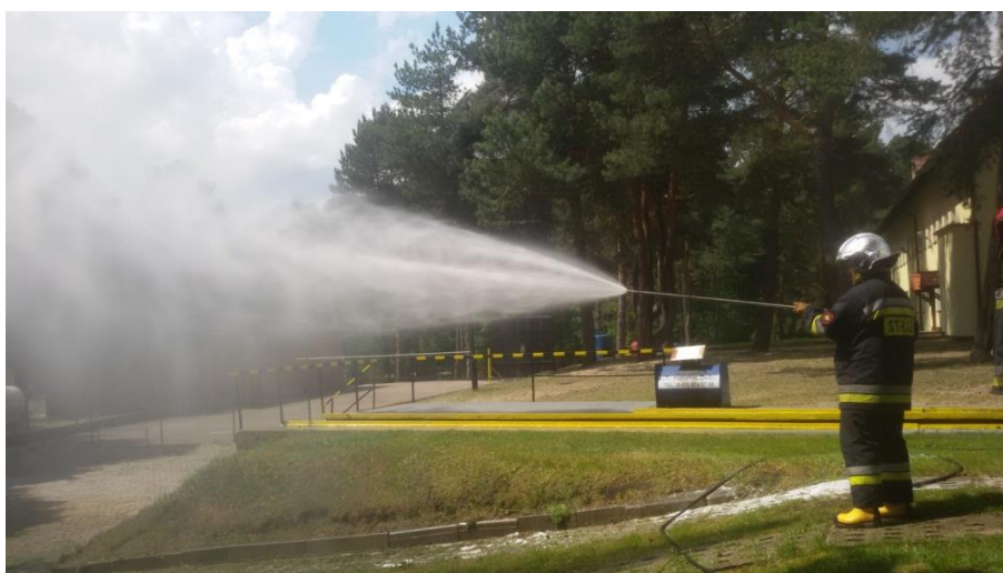
Fot. 145: Strumień mgły wodnej z lancy z głowicą do natarcia, wydajność około 80 L/min, ciśnienie na pompie 40 bar.
