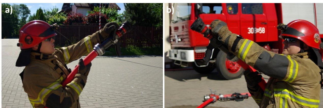
Fot. 72 a-b: Wysunięcie prądownicy dalej przed siebie pozwala na łatwiejsze celowanie prądem w różne miejsca (na boki, do góry, za siebie), bowiem dużą część ruchu uzyskuje się przemieszczając samą końcówkę linii gaśniczej. W ten sposób unika się pracy całym ciałem i męczącego wychylania się na boki w celu skierowania prądu gaśniczego w pożądaną stronę. Dłoń ręki trzymającej znajduje się przed łącznikiem, w podchwycie, a dodatkowo odcinek jest dociskany do ciała łokciem. Ręka operująca w pełni wyprostowana jest w stanie sięgnąć do wszystkich elementów regulujących prąd gaśniczy. W przypadku konieczności przemieszczenia się można prądownicę chwycić ponownie za rękojęć, a po zajęciu pozycji wrócić do chwytu za linię gaśniczą. Taki chwyt pozwala uniknąć problemu „cofającej się linii” pokazanego na kolejnym zdjęciu ( fot. 73 ). [86]
