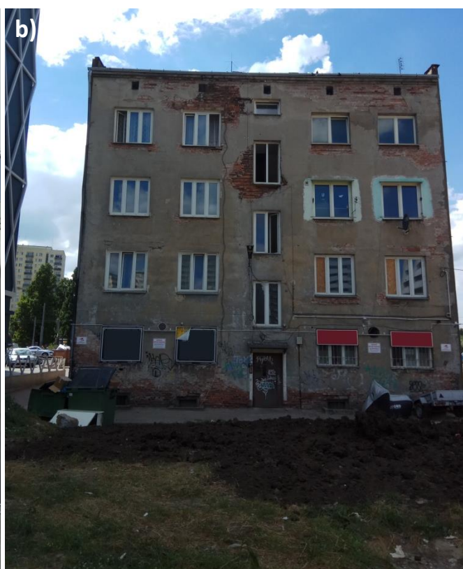
Fot. 41 a-b: Utrudnienia w korzystaniu z drabin. Po lewej : daszek zabezpieczający przed spadaniem przedmiotów na osoby stojące przy obiekcie uniemożliwi rozstawienie drabiny przystawnej i uzyskanie dostępu do pierwszych kondygnacji nad wejściem. Po prawej : bezpośrednie otoczenie budynku (plot, inny budynek, śmietniki, przyczepka) oraz rodzaj podłoża (miękki grunt) uniemożliwią sprawienie drabiny mechanicznej.
