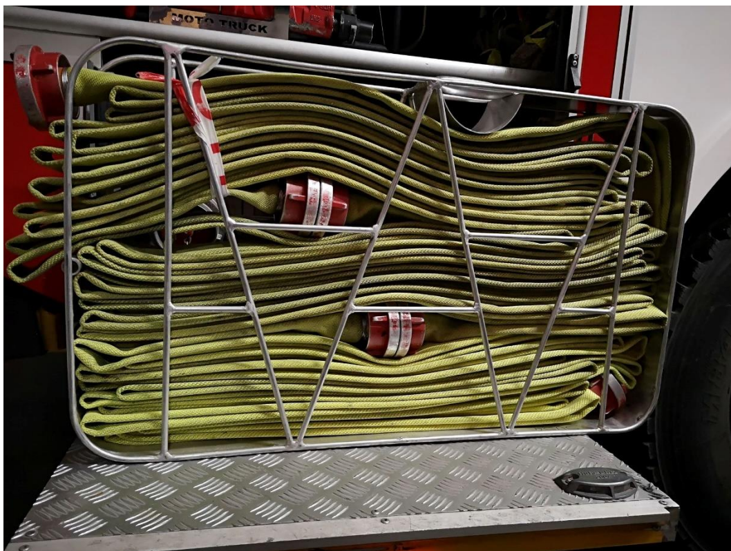
Fot. 93: 3 odcinki W-42 o łącznej długości około 60 m zwinięte w harmonijkę w kasetonie (fot.: Arkadiusz Frankiewicz)
