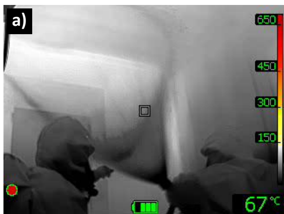
Fot. 126 a-b: Klatki z kamery taktycznej: po otwarciu drzwi widać wypływ gorących gazów pożarowych. Kamera w wysokim trybie czułości. Widać też peryferyjny obrys stożka mgły, pustego w środku (prądownica z pierścieniem mgłowym).
