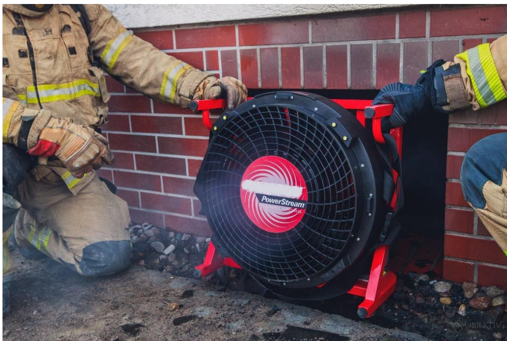
Fot. 164: Praca wentylatora wyciągowego przy usuwaniu dymu z piwnicy przez okno piwniczne. (fot. Piotr Zwarycz, Obiektiv.com)
