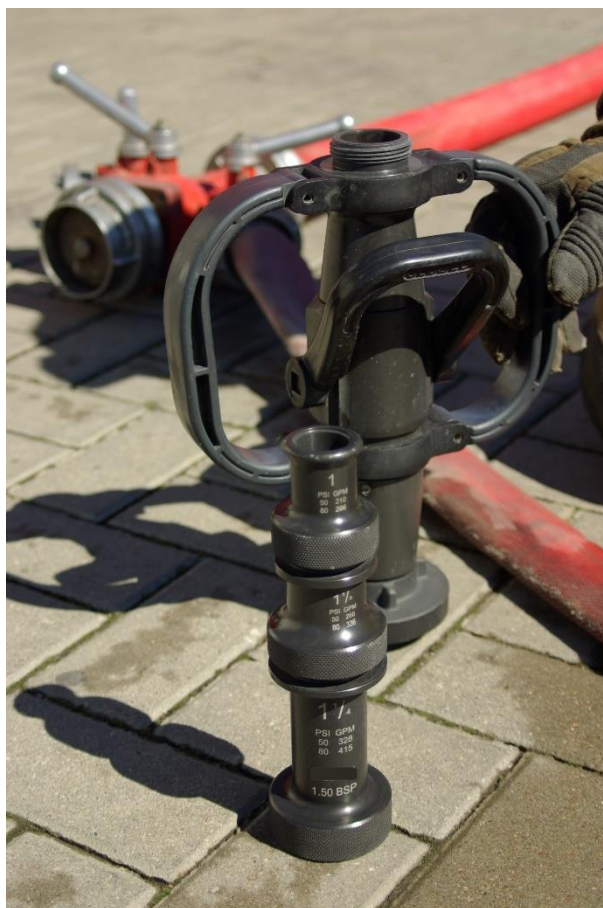
Fot. 85: Prądownice typu smoothbore czasami produkowane są w tzw. systemie kaskadowym. Mają wtedy kilka nakręcanych na siebie puszczków o różnych średnicach. Na zdjęciu widać prądownicę z 3 puszczkami, pracującymi przy 2 ciśnieniach nominalnych, co daje łącznie 6 możliwych wydajności przy pełnym otwarciu zaworu kulowego i zapewnia szeroką gamę zastosowań. Tego typu korpus, posiadający uchwyty z dwóch stron, nosi nazwę „playpipe” i jest najczęściej używany przy pożarach przemysłowych.
