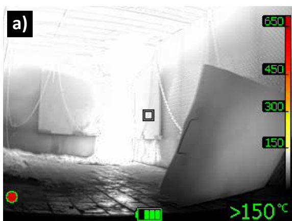
Fot. 127 a-b: różnice między wysokim (strona lewa) i niskim (strona prawa) trybem czułości. Zdjęcia wykonane w tym samym momencie, pokazujące ten sam widok.
