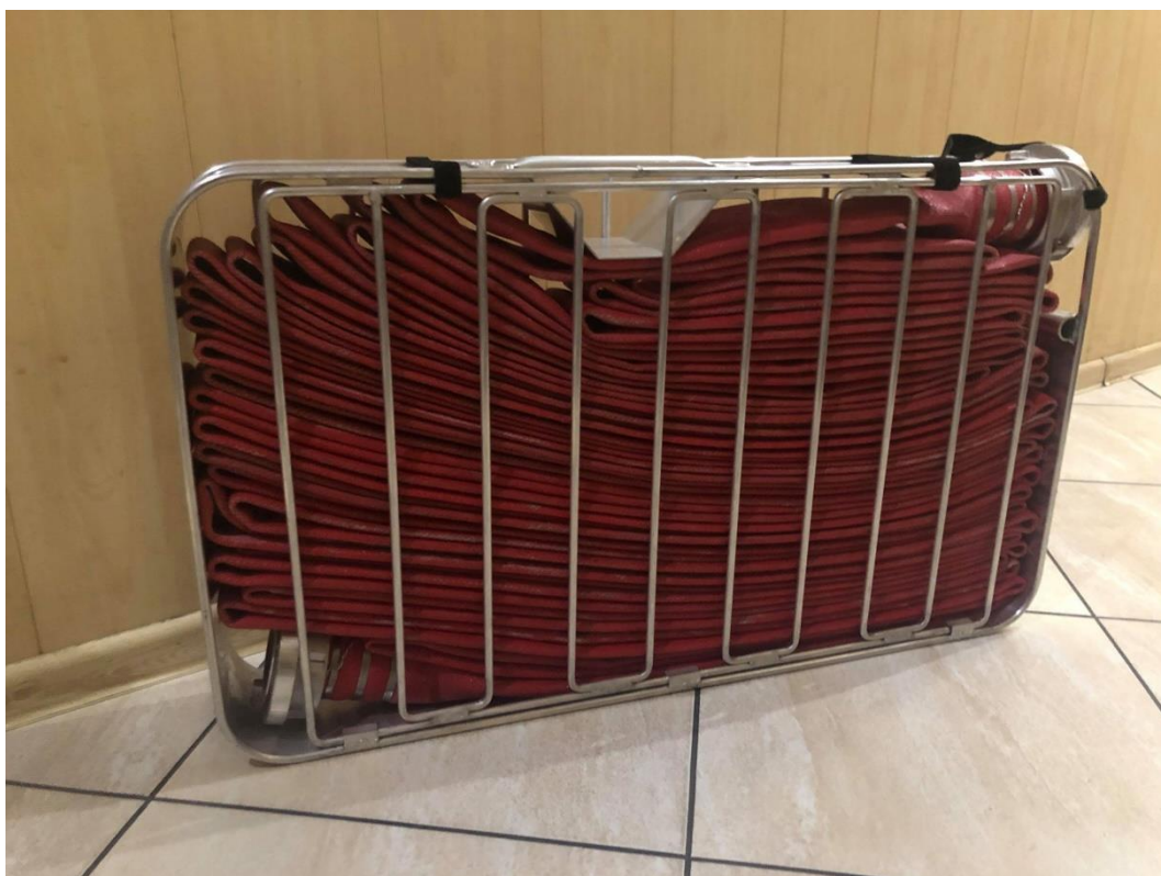
Fot. 93: Odcinek W-75 o długości 40 m zwinięty w harmonijkę w kasetonie. Element wyposażenia ciężkiego samochodu specjalnego z drabina mechaniczną SCD-42 (fot.: Krzysztof Brzozowski)
