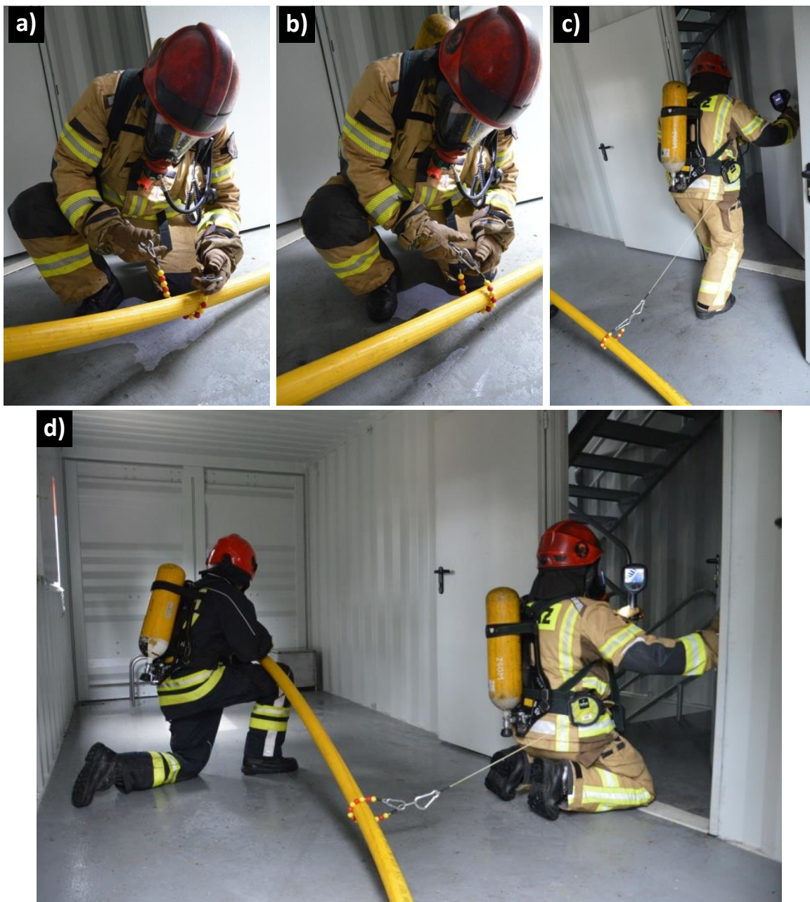
Fot. 133 a-d: Wykorzystanie autorolki znacznie usprawnia działanie. Można zapiąć ją na linii gaśniczej nawet w rękawicach ochronnych. Koralki występujące w wersji pokazanej na zdjęciu umożliwiają przesuwanie punktu zaczepienia wzdłuż linii bez blokowania na łącznikach czy przedmiotach leżących na podłożu. Na zdjęciach strażak odłącza się na niewielką odległość, utrzymując stały kontakt z linią gaśniczą i dokonuje sprawdzenia przylegającego pomieszczenia za pomocą kamery termowizyjnej. Autorolka pozwoli na sprawny powrót nawet przy niskiej widoczności bez dodatkowych czynności. Analogicznie wygląda praca z liną lub linką osobistą, jednak wymagają one zwijania w trakcie powrotu do partnera z rotą.
