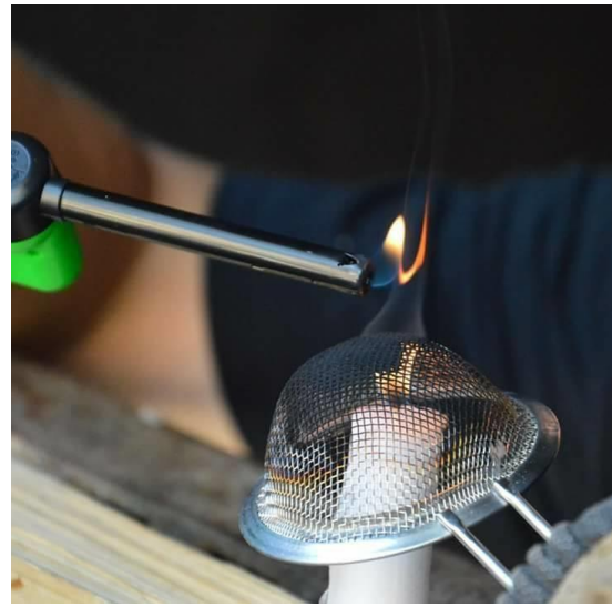
Fot. 8: Wprowadzając balast termalny (metalowe pręciki sitka) obniża się temperaturę płomienia i doprowadza do jego likwidacji. Paliwa są nadal zdolne do spalania – zapalenie płomienia ponad sitkiem powoduje powstanie drugiej strefy reakcji.
