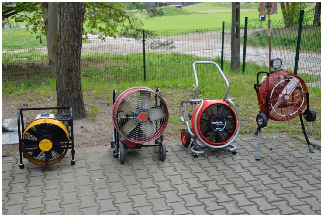
Fot. 161: Różne konstrukcje wentylatorów spalinowych, nadciśnieniowych. Od lewej: wentylator konwencjonalny (tradycyjny, wytwarzający strugę o kształcie stożka), osiowy. Następnie wentylator tradycyjny o napędzie pasowym. Kolejny z wentylatorów to turbowentylator (wytwarzający strugę w kształcie walca dzięki „kierownikom” zawężającym i przyspieszającym strumień powietrza). Wentylator po prawej to rzadko występujący wentylator śmigłowy (pozostałe na zdjęciu to wentylatory wirnikowe), który dla poprawnej pracy czerpie powietrze nie tylko zza urządzenia, ale i dookoła śmigła, przez co zamknięty jest w klatce (a nie pierścieniu) i wymaga pracy na wysuniętych nogach w celu uniknięcia zasysania zanieczyszczeń i wyrzucania ich wraz ze strugą.
