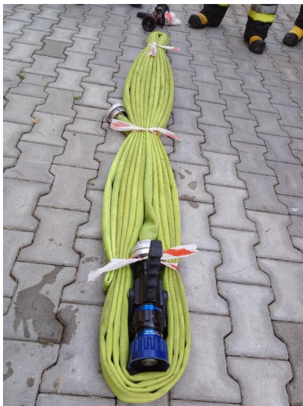
Fot. 96: Przygotowany pakiet węzowy ma długość około 2-2,5 m. Ważne, aby wiązanie obejmowało prądownicę, która jako ciężki element może wypaść z pakietu podczas transportu i utrudniać sprawne przygotowanie pakietu do prac. Zazwyczaj pakiet należy związać (lub zabezpieczyć w inny sposób) w trzech miejscach, aby uniknąć jego rozpadania się w trakcie transportu.
