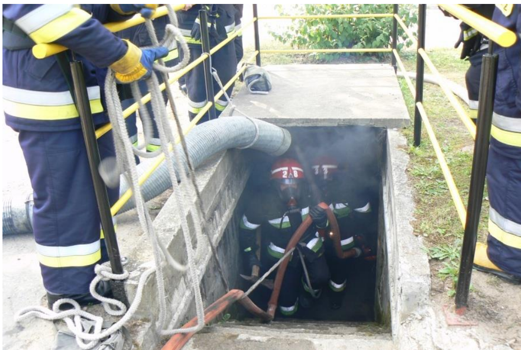
Fot. 162: Dosyć popularnym sprzętem w straży były kiedyś wentylatory wyciągowe (agregaty oddymiające) VTA-60. Wyposażone były w specjalne rękawy do kierunkowania wyciąganych gazów. Był to sprzęt produkowany w latach 60-tych i 70-tych. Praca tego agregatu była bardzo hałaśliwa. Wydajność wyciągowa sięgała rzędu 60 [m 3 /min] czyli około 3600 [m 3 /h]. Tego typu sprzęt był często stosowany przy pożarach piwnic. Łączna długość zestawu rur wynosiła 17 m (10 odcinków po 1,7 m każdy). (fot. Ośrodek Szkolenia KW PSP w Olsztynie).
