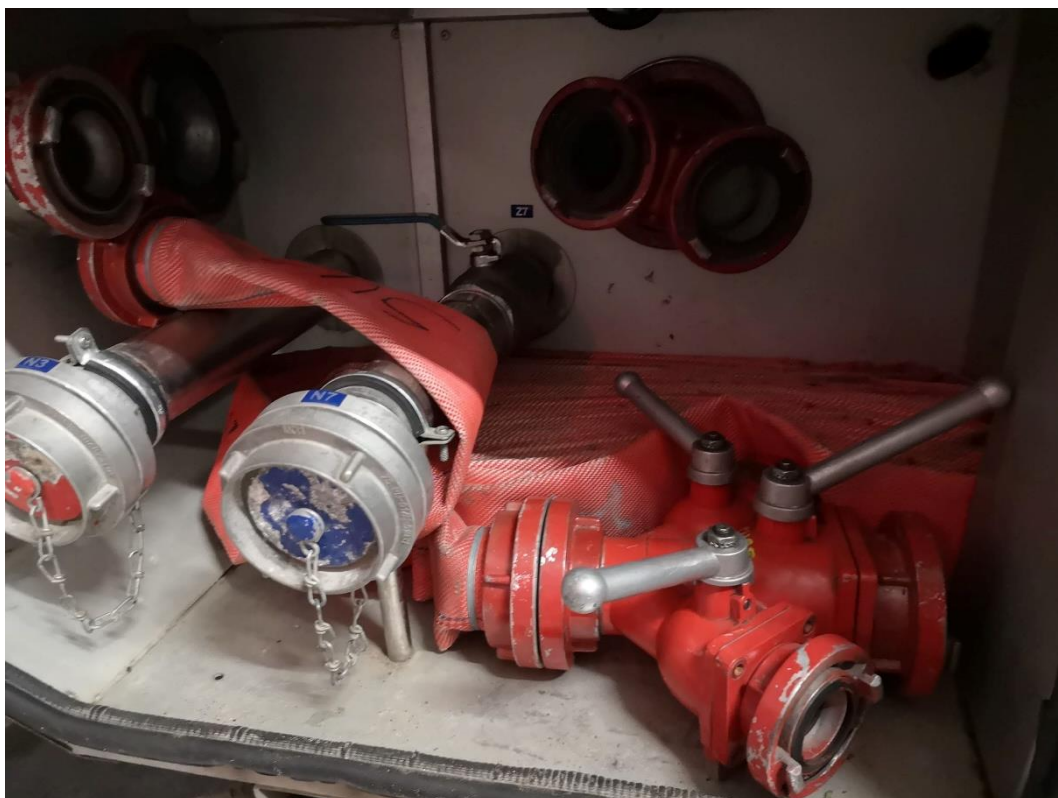
Fot. 91: Odcinek W-75 zwinięty w harmonijkę z podłączonym rozdzielaczem – szybka linia główna. (fot.: Arkadiusz Frankiewicz) 38
