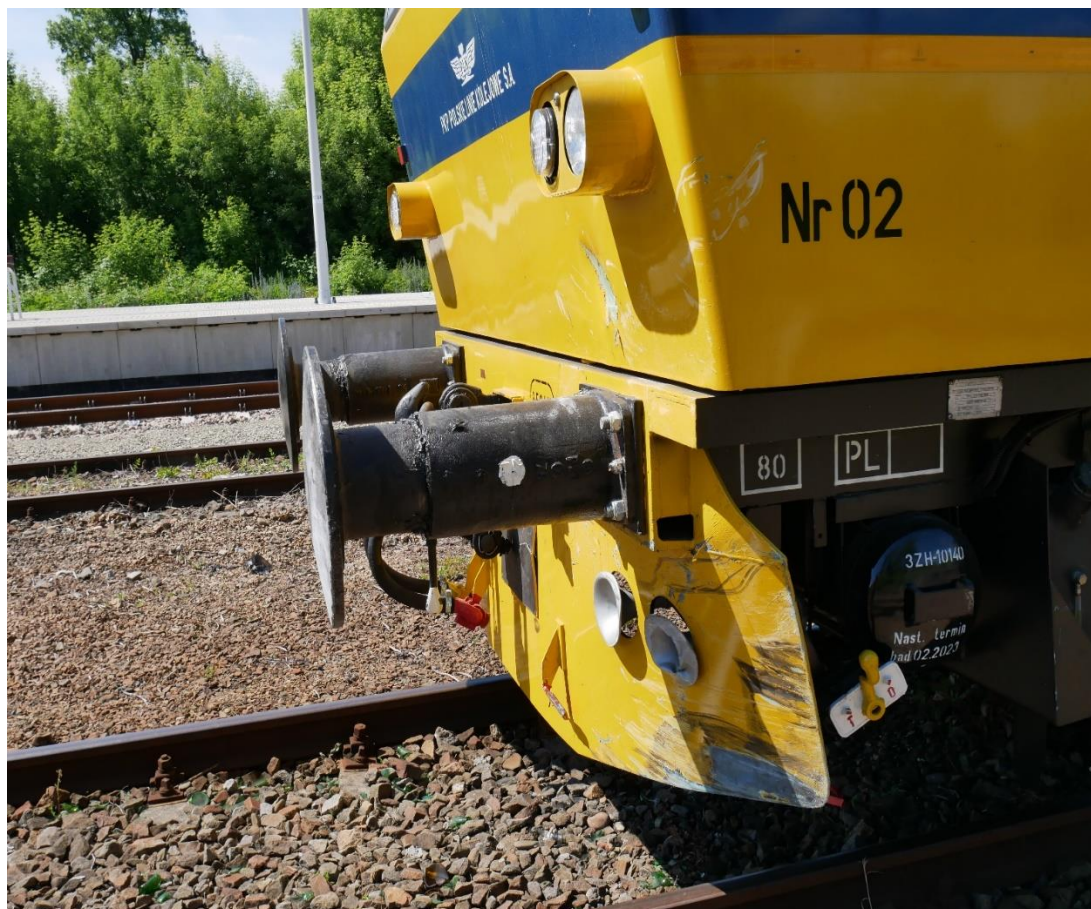
Zdjęcie 6 - Uszkodzenia pojazdu kolejowego po wypadku (fot. PKBWK)
