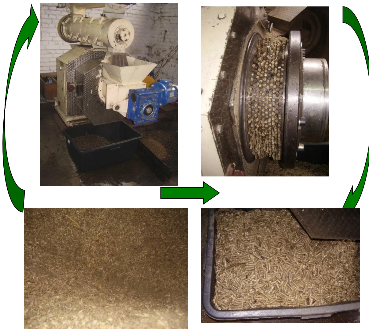
Fot. 6.2. Widok granulatora, matrycy pierścieniowej, substratu po wysuszeniu i granulatu –końcowego produktu.
