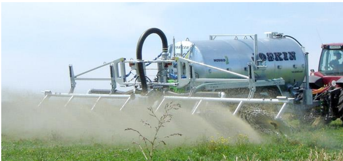
Fot. 6.8. Wóz asenizacyjny z aplikatorem w postaci ramion umieszczonych na rampie [www.joskin.com, 2022]
