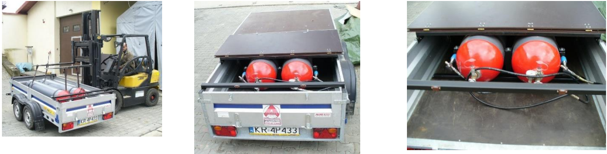
Fot. 2.4. Widok przyczepy transportowej z butlami z biometanem wraz z ich zabezpieczeniem na przyczepie [materiały własne]
