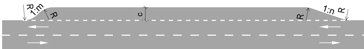
Rys. 10.3.1. Zatoka postojowa bez jezdni manewrowej (otwarta)
