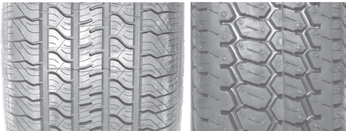
Rysunek 2. Widok bieżnika opon referencyjnych, po lewej P1, po prawej H1 Początkowa głębokość rzeźby bieżnika mierzona w obwodowych rowkach musi wynosić:
