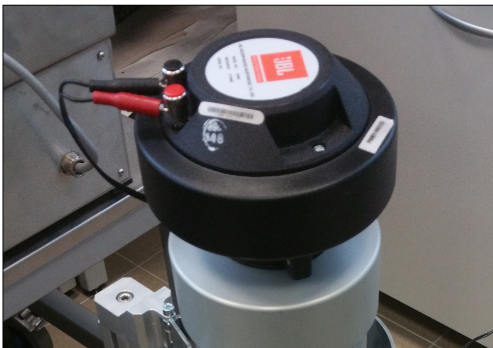
Fot. 2.2. Widok i sposób montażu głośnika w rurze impedancyjnej
