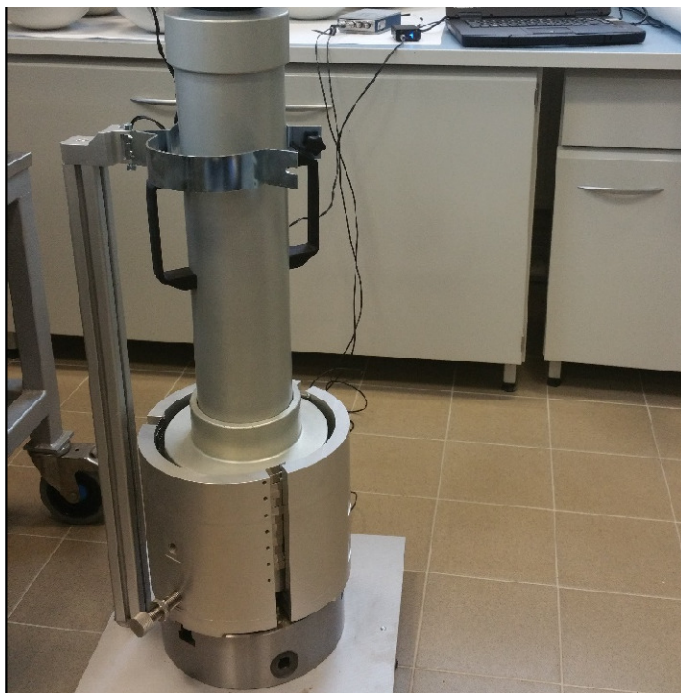
Fot. 3.1. Widok przykładowego zestawu pomiarowego wykorzystywanego do pomiarów współczynnika pochłaniania dźwięku w warunkach laboratoryjnych
