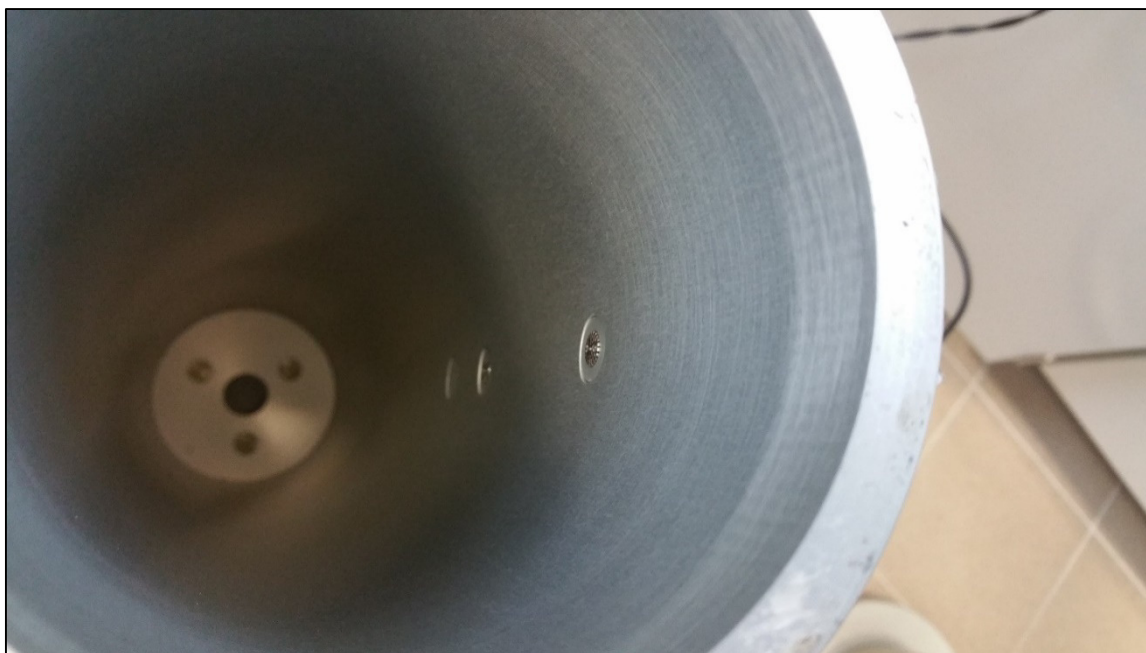
Fot. 2.1. Sposób montażu mikrofonów pomiarowych w rurze impedancyjnej – widok wnętrza urządzenia.
