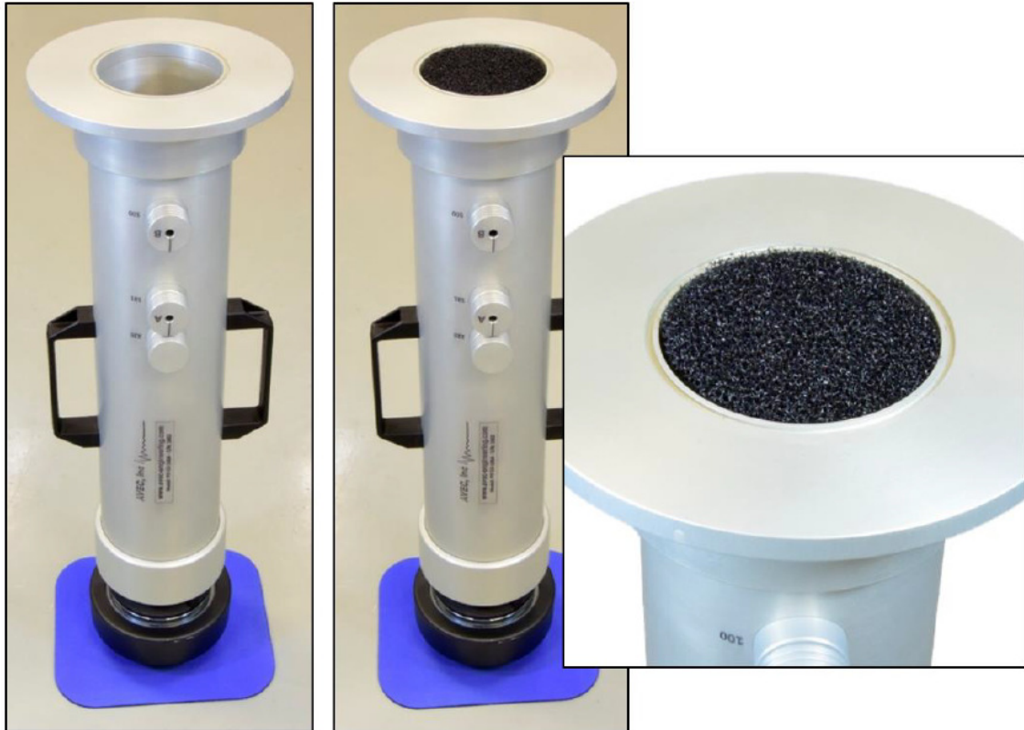
Fot. 3.2. Przykładowe ustawienie sprzętu pomiarowego z użyciem materiału silnie pochłaniającego dźwięk w celu wykonania kalibracji mającej na celu zminimalizowanie różnic w charakterystykach amplitud i faz mikrofonów pomiarowych [4]
