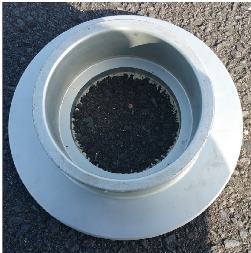
Fot. 2.10. Widok łącznika „in situ” szczelnie zamontowanego na badanej nawierzchni drogowej za pomocą kitu sanitarnego
