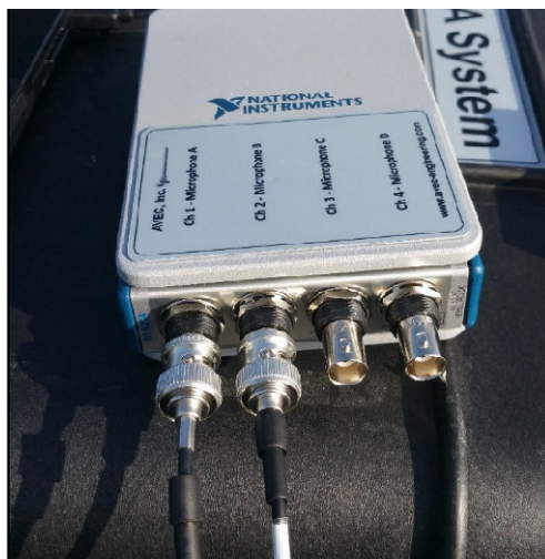
Fot. 2.8. Widok analizatora dźwięku używanego do wykonania pomiarów współczynnika pochłaniania dźwięku w ramach opracowania.
