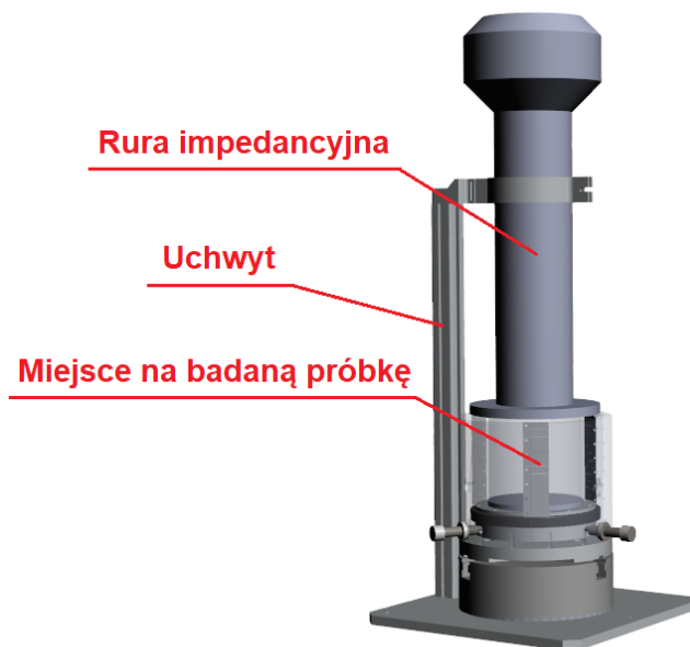
Rys. 3.1. Szkic stanowiska do pomiarów współczynnika pochłaniania dźwięku w warunkach laboratoryjnych
