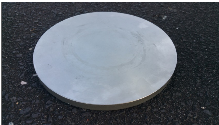
Fot. 2.5. Stalowa płytką referencyjną o grubości ok. 10 mm używana do pomiarów kalibracyjnych
