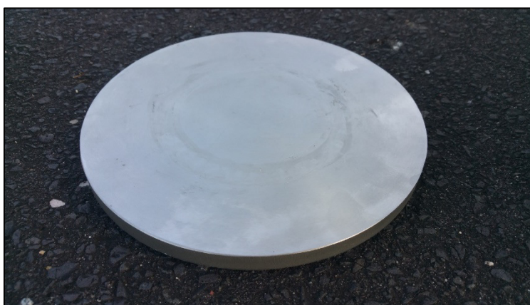
Fot. 2.7. Stalowa płytki referencyjna o grubości ok. 10 mm używana do pomiarów kalibracyjnych
