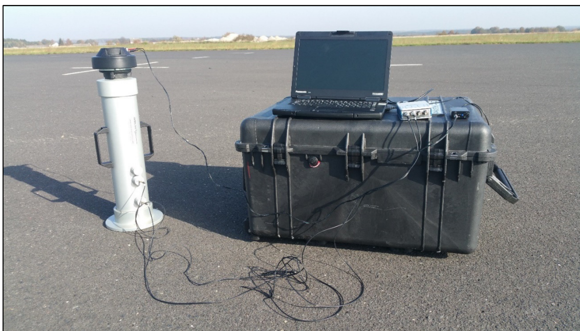
Fot. 2.4. Widok rury impedancyjnej wykorzystywanej do pomiarów współczynnika pochłaniania nawierzchni drogowych wraz z dodatkowym wyposażeniem
