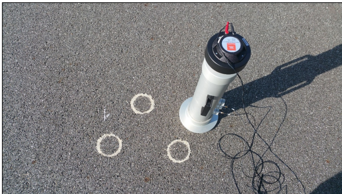
Fot. 4.1. Przykładowa lokalizacja punktów, w których została wykonany pomiar współczynnika pochłaniania dźwięku na wybranej nawierzchni zastosowanej na odcinku badawczym w Bolimowie koło Warszawy.
