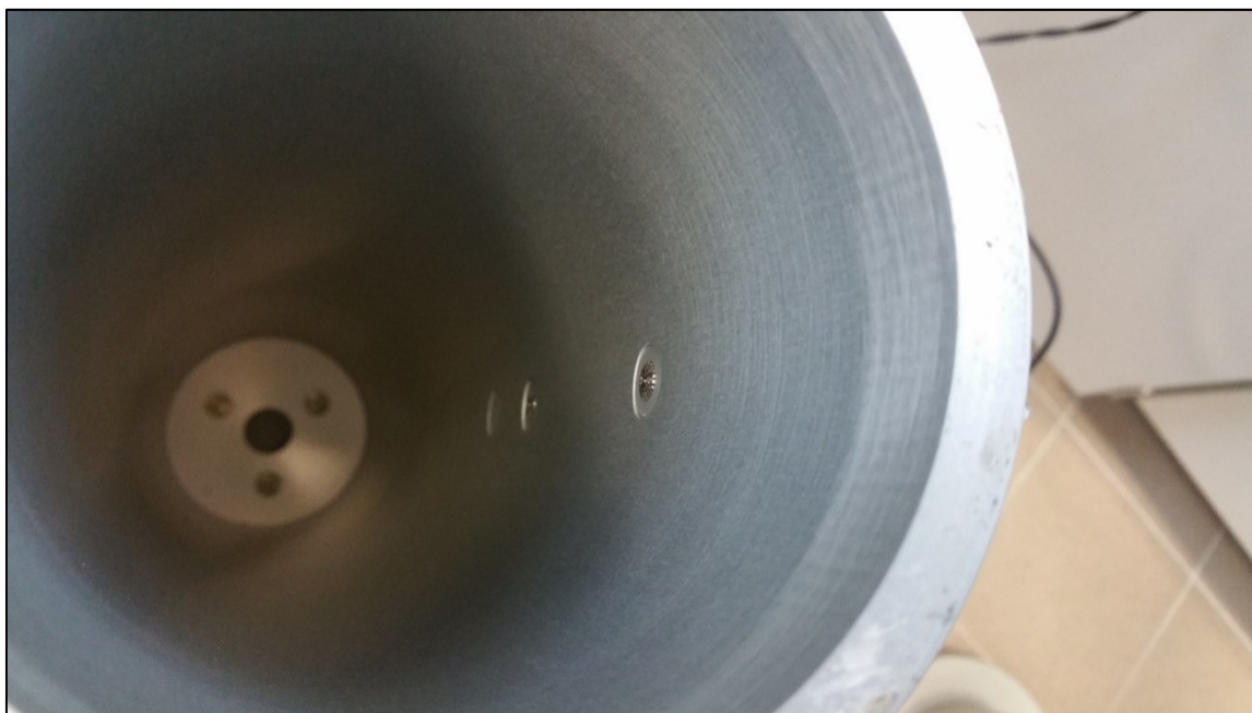
Fot. 2.2. Sposób montażu mikrofonów pomiarowych w rurze impedancyjnej – widok wnętrza urządzenia.
