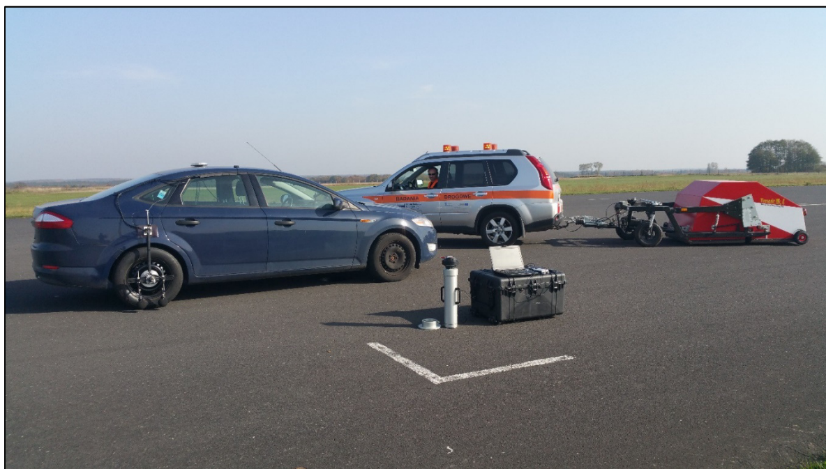
Fot. 3.11. Sprzęt pomiarowy użyty do wykonania pomiarów na odcinku testowym (tor Ułęż pod Dęblinem) – metody OBSI, CPX i rury impedancyjnej.
