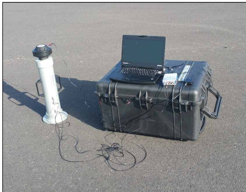
Fot. 6.1. Widok przykładowego zestawu pomiarowego wykorzystywanego do pomiarów współczynnika pochłaniania dźwięku w warunkach „in situ”
