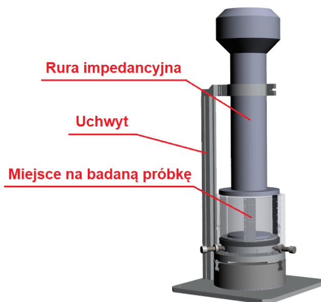
Rys. 6.1. Szkic stanowiska do pomiarów współczynnika pochłaniania dźwięku w warunkach laboratoryjnych
