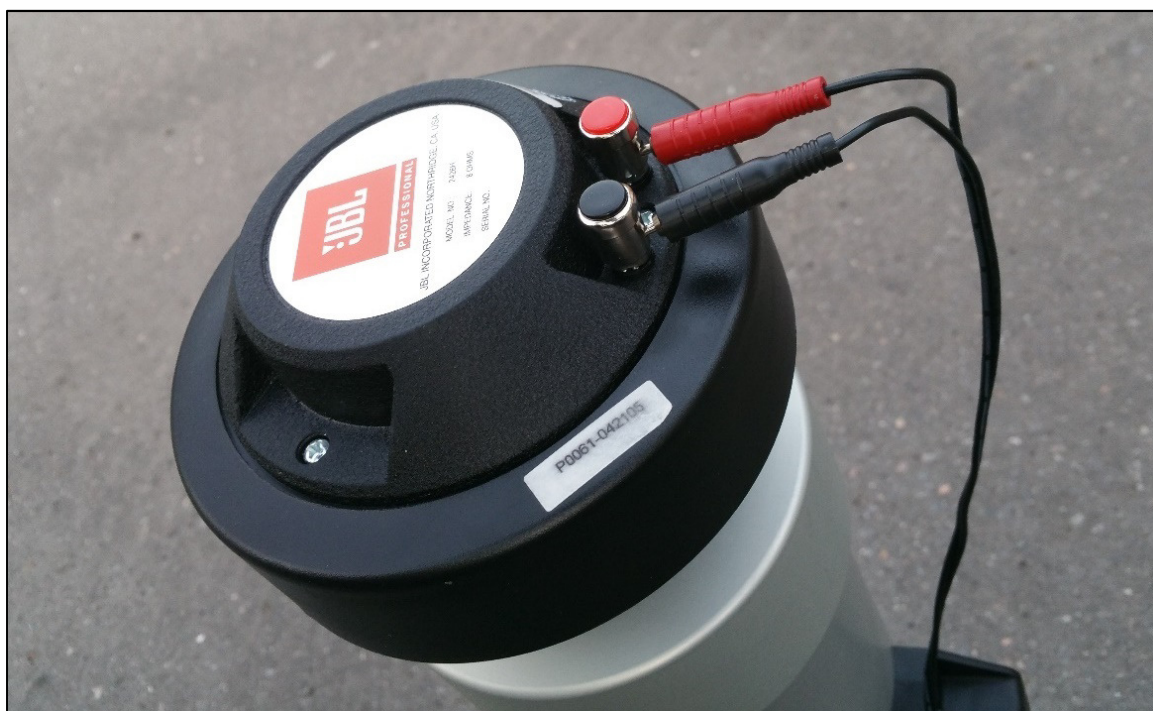
Fot. 2.3. Widok i sposób montażu głośnika w rurze impedancyjnej
