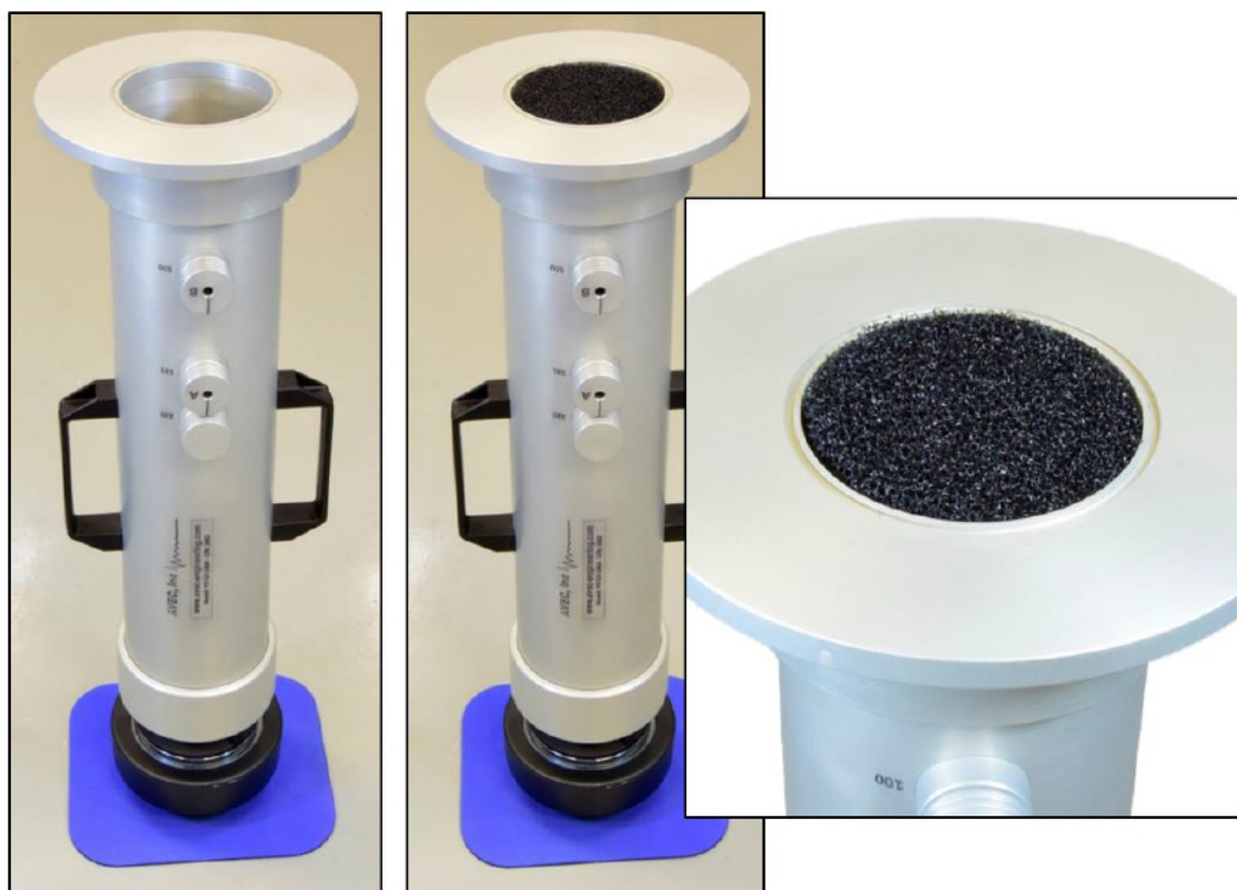
Fot. 6.2. Przykładowe ustawienie sprzętu pomiarowego z użyciem materiału silnie pochłaniającego dźwięk w celu wykonania kalibracji mającej na celu zminimalizowanie różnic w charakterystykach amplitud i faz mikrofonów pomiarowych [127]
