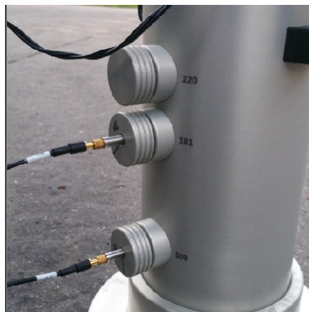
Fot. 2.6. Widok portów mikrofonowych wykonanych w ściśle określonych odległościach od badanej nawierzchni drogowej w urządzeniu wykorzystanym do wykonywania pomiarów w ramach niniejszego opracowania.
