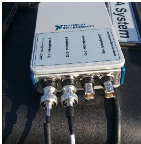
Fot. 2.10. Widok analizatora dźwięku używanego do wykonania pomiarów współczynnika pochłaniania dźwięku w ramach opracowania.
