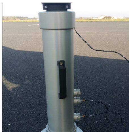
Fot. 2.1. Widok rury impedancyjnej użytej do wykonania pomiarów współczynnika pochłaniania nawierzchni
