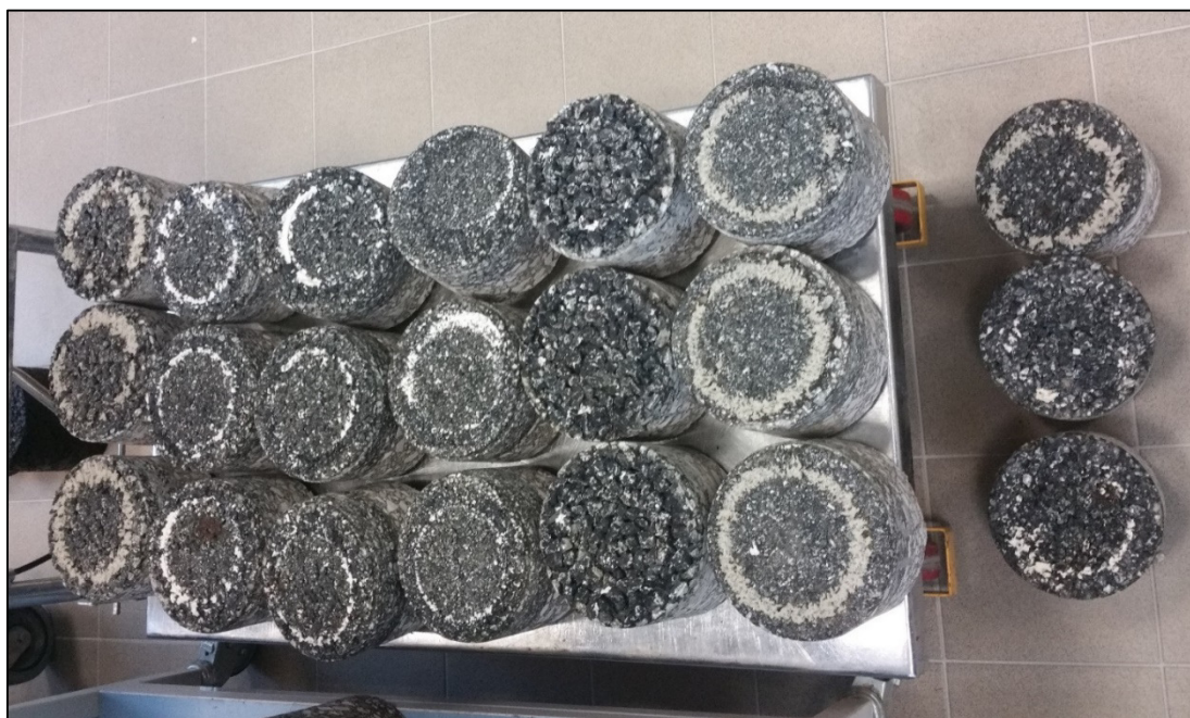
Fot. 4.2. Widok próbek nawierzchni pobranych z odcinka badawczego w Bolimowie, na których wykonano pomiary w warunkach laboratoryjnych.
