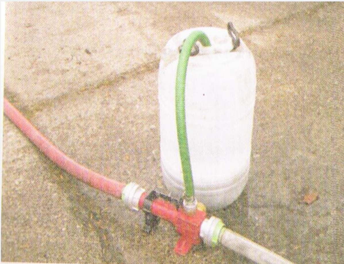
Zasysacz liniowy wraz z beczką ze środkiem pianotwórczym
