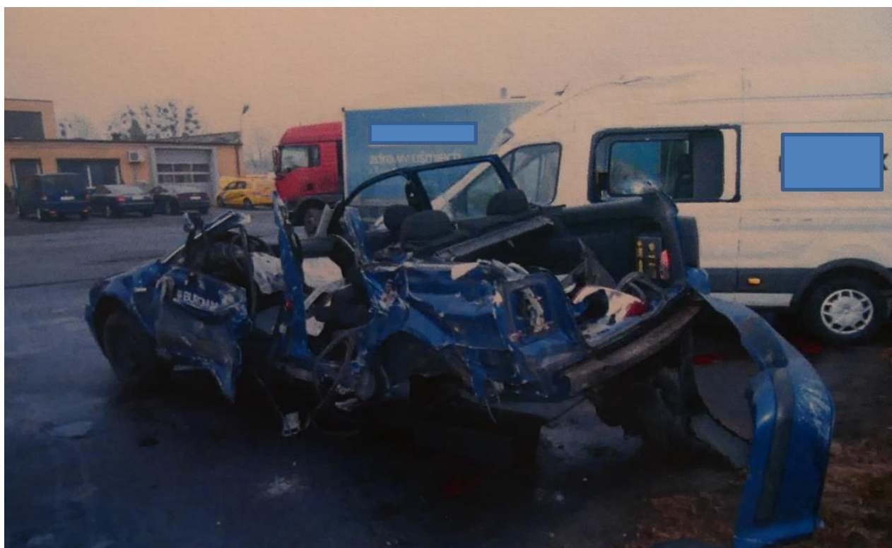
Fot. 14 i 15. Uszkodzenia samochodu
