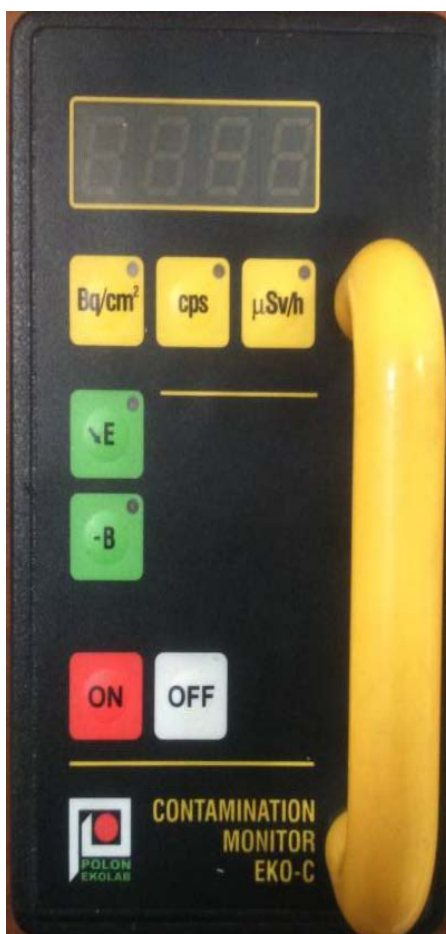
Fot. 26. Monitor skażeń radioaktywnych EKO-C. Źródło własne
