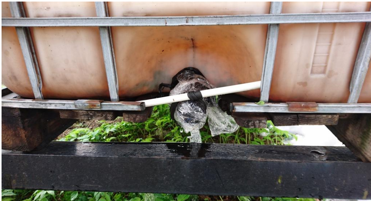
Fot. 40. Uszczelnienie zaworu zbiornika DPPL gumą i folią stretch. Źródło własne
