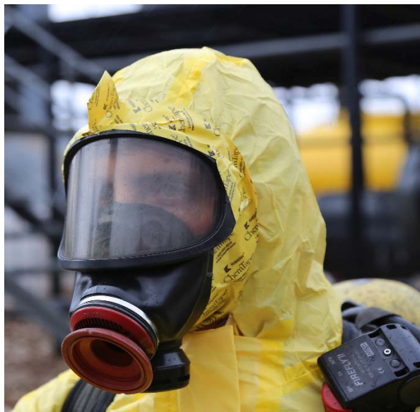
Fot. 12-13. Połączenie ramki wizjera maski pełnotwarzowej z kapturem ubrania ochronnego przy użyciu taśmy. Źródło własne
