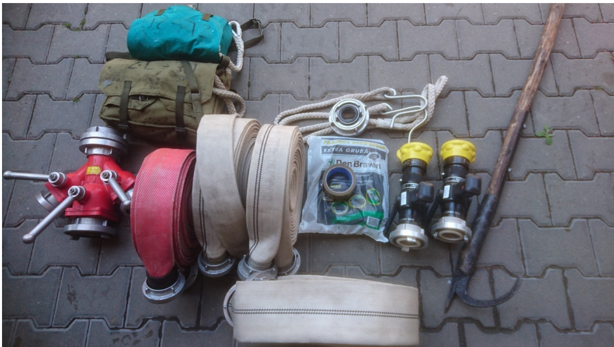
Fot. 50. Sprzęt do sprawienia stanowiska dekontaminacji wstępnej. Źródło: materiały własne
