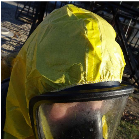
Fot. 12-13. Połączenie ramki wizjera maski pełnotwarzowej z kapturem ubrania ochronnego przy użyciu taśmy. Źródło własne
