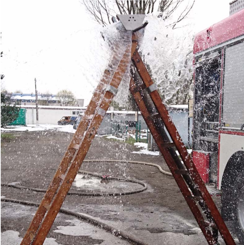
Fot. 54. Prowizoryczne stanowisko dekontaminacyjne z wykorzystaniem linii gaśniczej zakończonej zastoną wodną i drabiny przenośnej. Źródło: materiały własne
