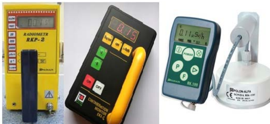
Fot. 11. Wybrane przyrządy dozymetryczne przeznaczone do pomiaru skażeń promieniotwórczych, znajdujące się na wyposażeniu PSP. Źródło własne
