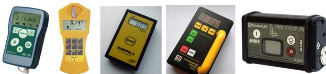
Fot. 9. Wybrane przyrządy dozymetryczne przeznaczone do pomiaru mocy dawki promieniowania jonizującego, znajdujące się na wyposażeniu PSP. Źródło własne
