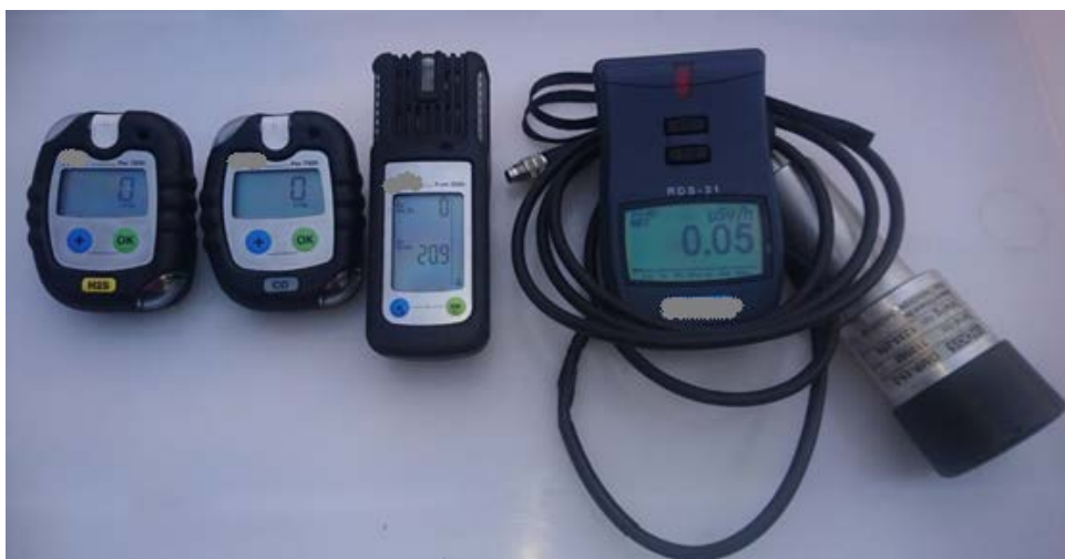
Fot. 4. Zestaw przyrządów umożliwiających pomiar: stężeń wybuchowych, tlenu, tlenku węgla i siarkowodoru i urządzenie wykrywające promieniowanie jonizujące. Źródło własne
