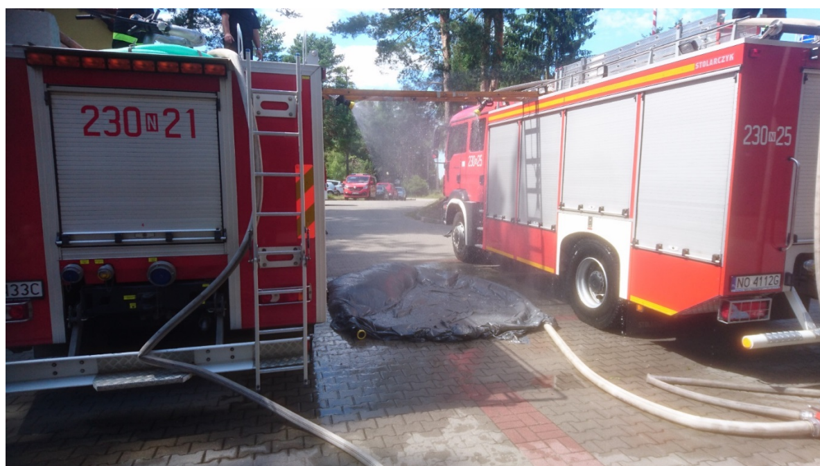
Fot. 55-56. Prowizoryczne stanowisko dekontaminacyjne z wykorzystaniem linii gaśniczej i pojazdów pożarniczych. Źródło: materiały własne
