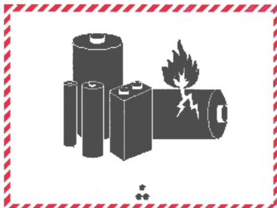
Rys. 25. Znak dla akumulatorów litowych – stosowany na sztukach przesyłki zawierających ogniwa lub akumulatory litowe (* - numer lub numery UN, ** - miejsce na numer telefonu w celu uzyskania dodatkowych informacji)
