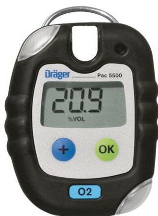
Fot. 25. Przykładowy przyrząd do pomiaru stężenia tlenu. Źródło własne
