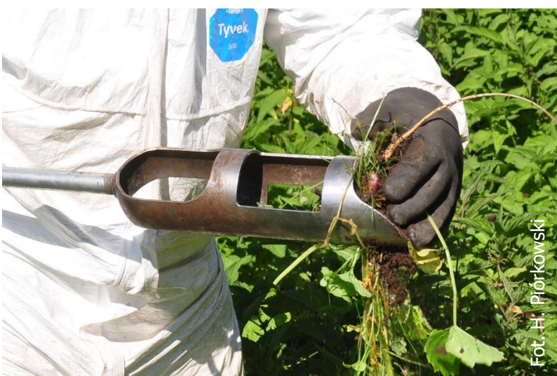
Czyszczenie cylindra doglebowego
