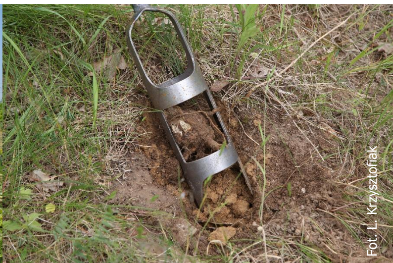
Korzeń usuwany za pomocą cylindra doglebowego
