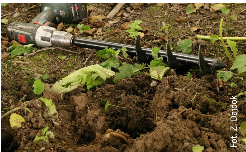
Wiertnia świdra doglebowego używana podczas realizacji metody
