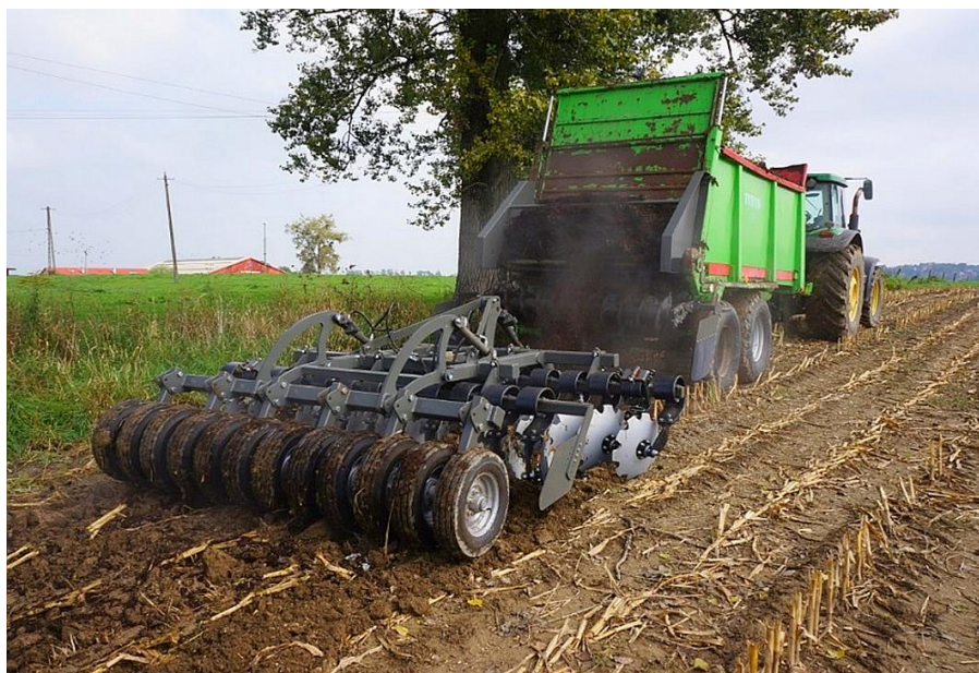
Fot. 14. Modułowy zestaw do aplikacji i bezpośredniego przykrywania obornika
