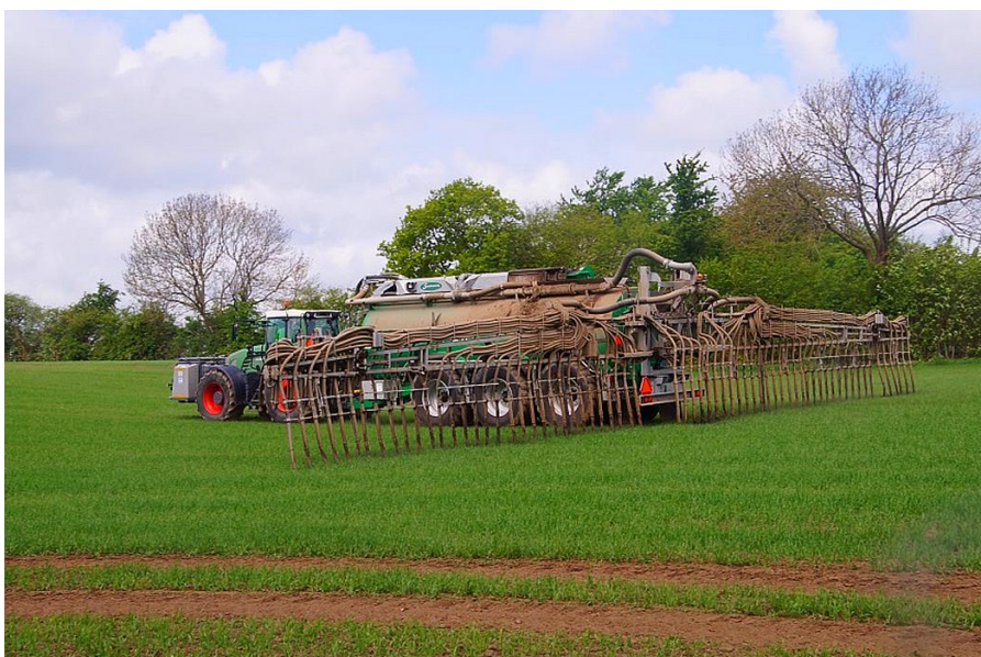
Fot. 13. Zakwaszanie gnojowicy w systemie „in field”
