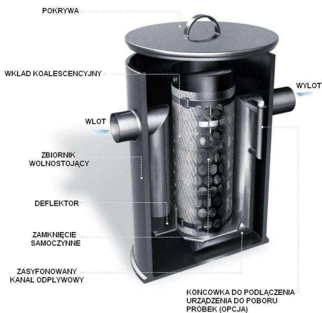
Rys. 8.5.2.2. Przykład rozwiązania separatora koalescencyjnego [20][26][21][44]
