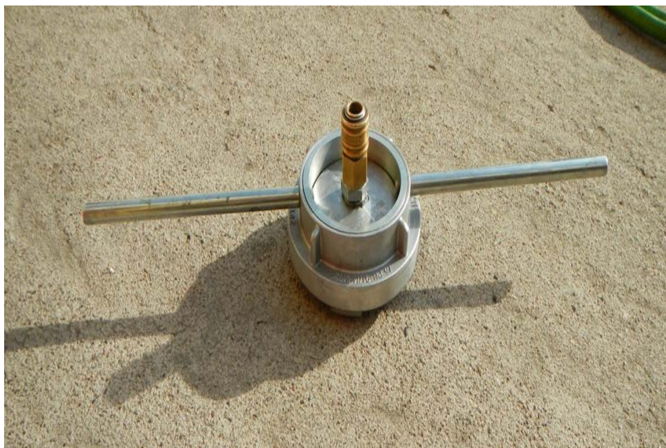
Zdj. 33 Pokrywa z króćcem pneumatycznym i uchwytem Autor: asp. Krzysztof Bartoszak
