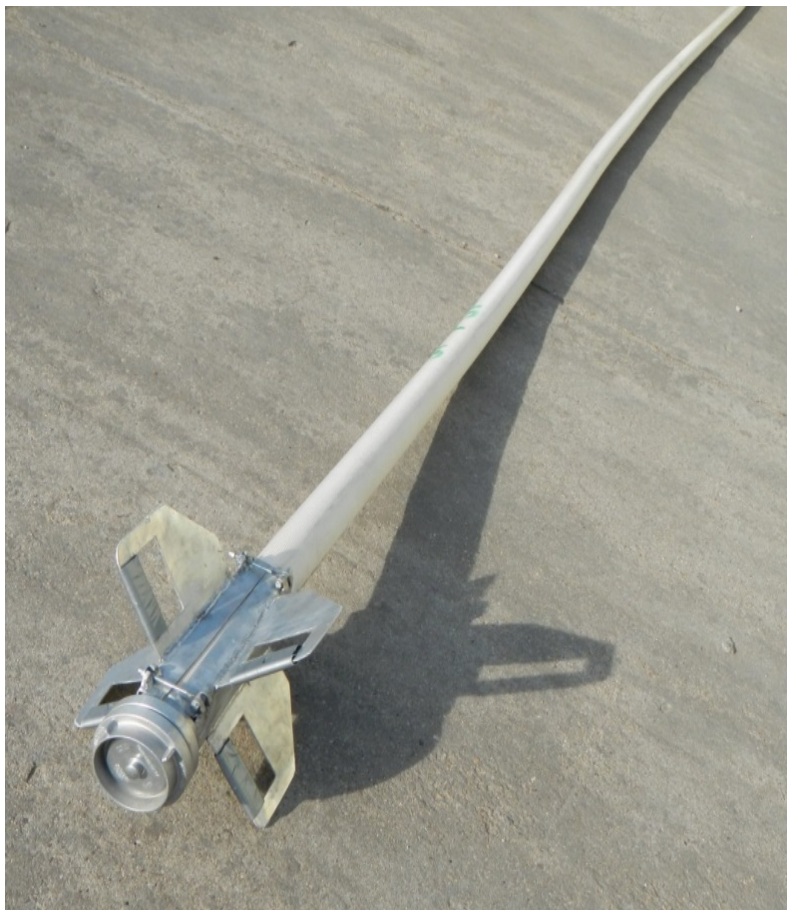
Zdj. 36 Gotowy do użycia zestaw po napełnieniu powietrzem z butli z taśmą pożarniczego węża tłocznego Autor: asp. Krzysztof Bartoszek
