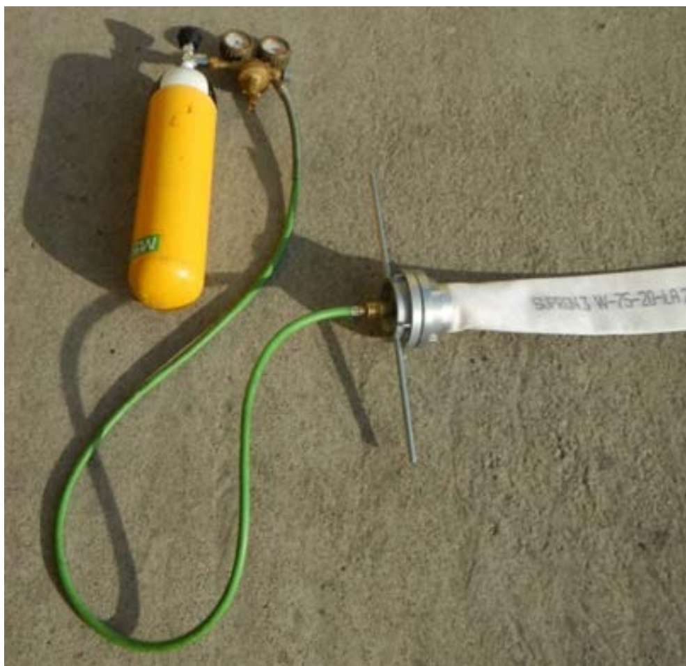
Zdj. 35 Połączenie butli z reduktorem ciśnienia i pokrywą z króćcem pneumatycznym
