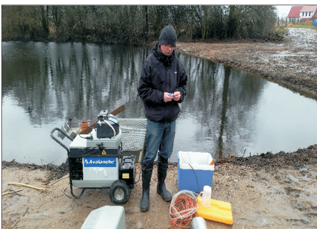
Ryc. 34. Przygotowanie próbopobieraka typu Avalanche do przeprowadzenia średniobowego poboru prób ścieków odprowadzanych z oczyszczalni
