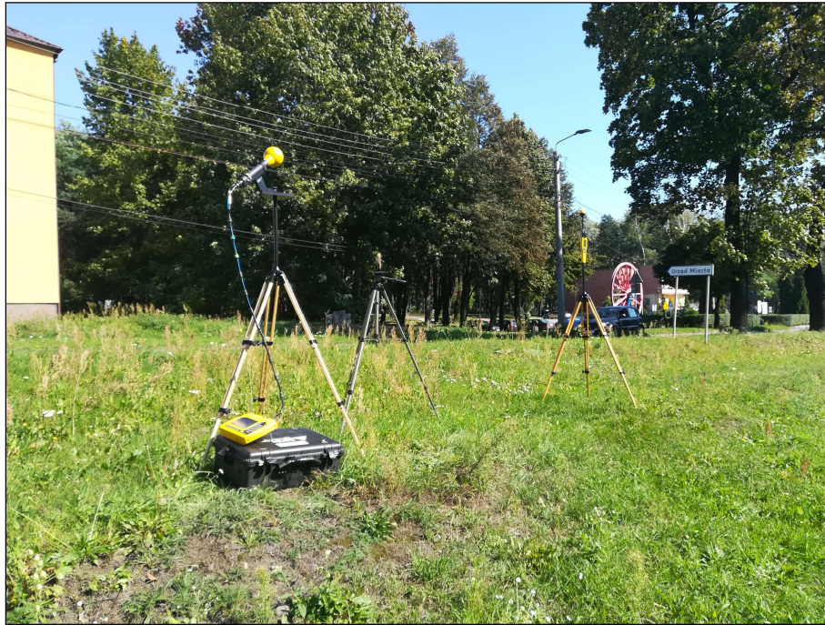
Fot. 3. Rejon badań, widok w kierunku południowym – ul. Jana III Sobieskiego; Na planie pierwszym: Selektywny analizator widma promieniowania elektromagnetycznego SRM – 3006 (typ, model, wg wzoru), prod. Narda – STS GmbH, Germany, w trakcie pracy
