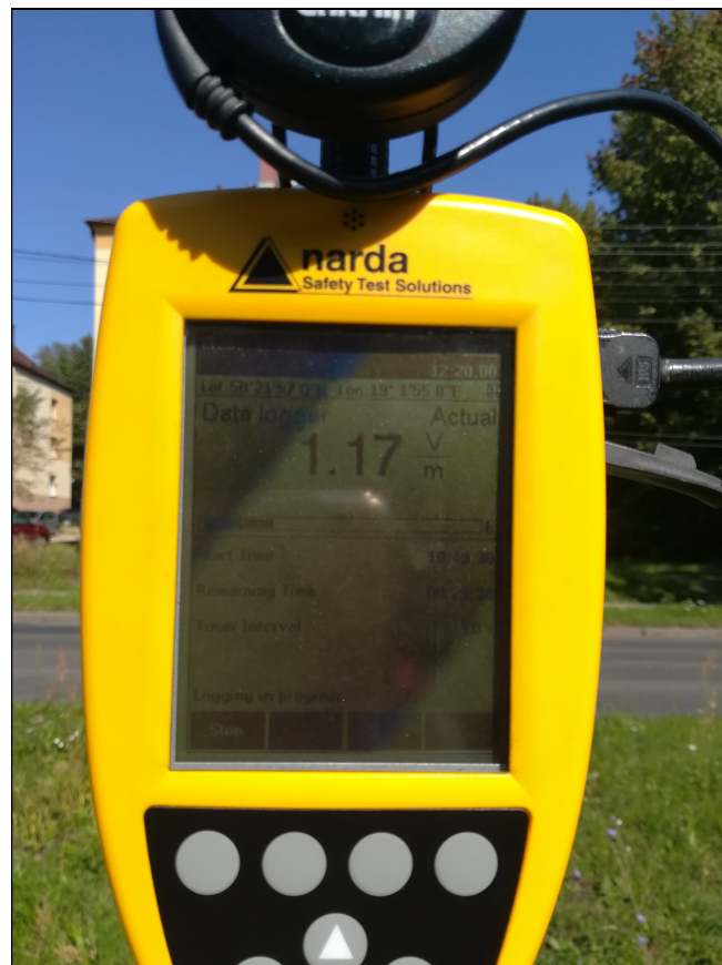
Fot. 4. Miernik poziomu pól elektromagnetycznych Narda NBM – 550 (typ, model, wg wzoru), prod. Narda – STS, GmbH, Germany, w trakcie prowadzonego badania
