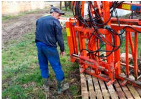
Brak podpór i zabezpieczeń przed niekontrolowanym przesunięciem maszyn rolniczych
