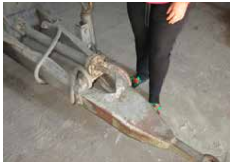
Brak podpór i zabezpieczeń przed niekontrolowanym przesunięciem maszyn rolniczych
