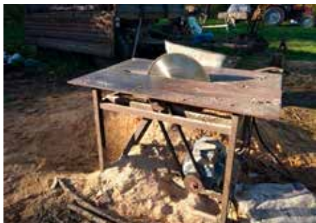
Balagan w miejscu pracy, użytkowanie krajzég nieposiadających żadnych zabezpieczeń i osłon elementów ruchomych
