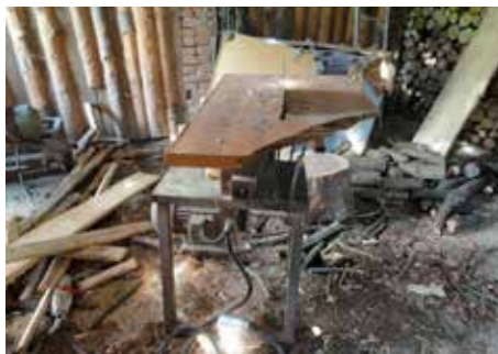
Balagan w miejscu pracy, użytkowanie krajzég nieposiadających żadnych zabezpieczeń i osłon elementów ruchomych
