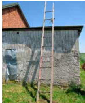
Krótkie, nieprawidłowo skonstruowane i ustawione drabiny, bez zabezpieczeń przed przechyłem i osunięciem
