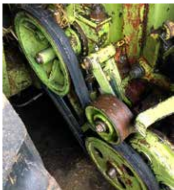
Brak osłon i zabezpieczeń elementów ruchomych maszyn i urządzeń
