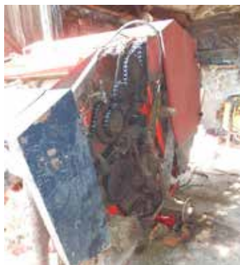
Brak osłon i zabezpieczeń elementów ruchomych maszyn i urządzeń
