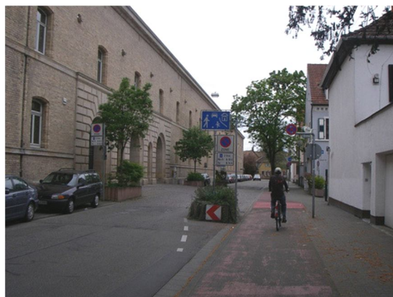
Rys. 3.7. Przykłady zastosowania dodatkowych środków budowlanych przy wjazdach do stref zamieszkania. Źródło: [3].
