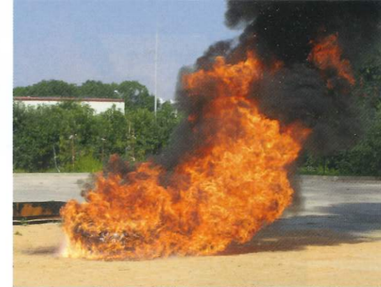
Początkowa faza wyrzutu ze zbiornika testowego fot. ZSP PERN SA 998, YouTube
