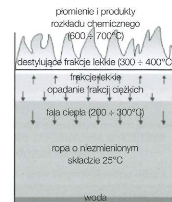
Rys. 1. Rozprzestrzenianie się warstwy przegrzanej (fali ciepła) podczas pożarów zbiorników z ciężkimi produktami naftowymi
