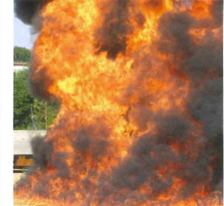
Wyrzut palącej się ropy naftowej. Kilkokrotne zwiększenie powierzchni pożaru. fot. ZSP PERN SA 998, YouTube
