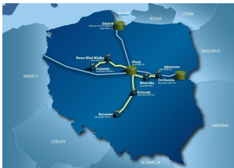
Rysunek 34. Aktualny system rurociągów ropy naftowej w Polsce, Źródło: PERN
