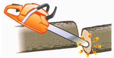
Rys.37 Ryzyko odbicia przy okrzyszowaniu.
