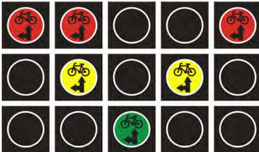
Rys. 3.17. Sygnalizatory kierunkowe S-3a dla kierujących rowerami do jazdy na wprost i skręcających w lewo
