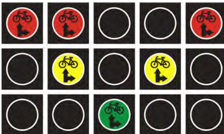
Rys. 3.18. Sygnalizatory kierunkowe S-3a dla kierujących rowerami do jazdy na wprost i skręcających w prawo
