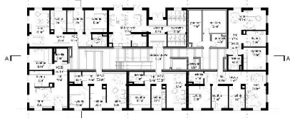
plan parteru budynku typowego - wszystkie typy mieszkań z możliwością dostosowania dla osób z niepełnosprawnymi, skala 1:200
