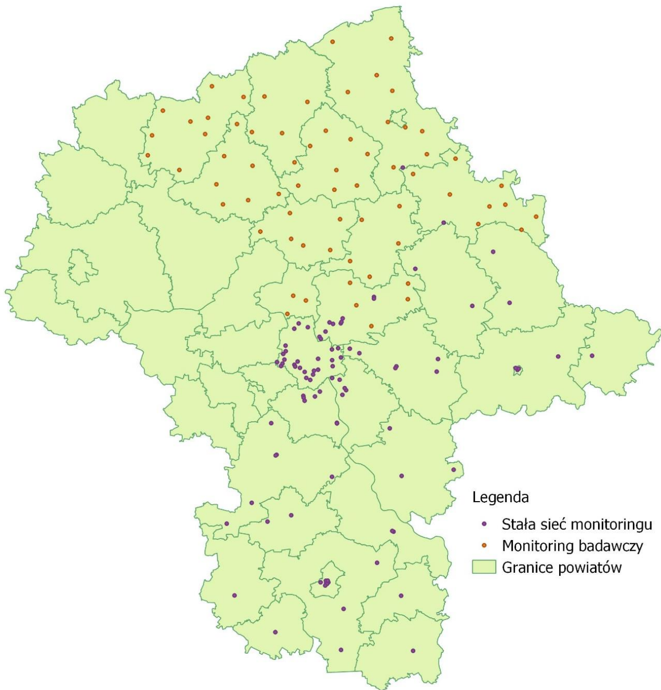
Ryc. 1. Lokalizacja punktów pomiarowych wyznaczonych w 2022 r. na terenie województwa mazowieckiego w ramach stałej sieci monitoringu oraz monitoringu badawczego.
