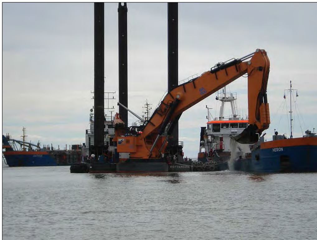
Rys. 6-16 Pogłębiarka podsiebnierna z błotniarką zacumowaną obok niej (po prawej).
