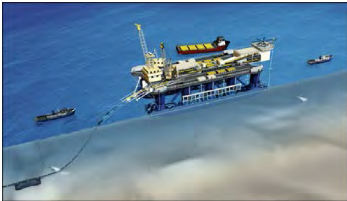
Rys. 6-11 Statek układający rury w systemie S-lay i pomocnicze statki badawcze.
