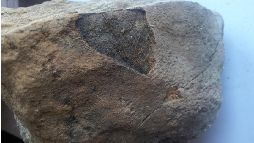
Fot. 7. Widok makroskopowy bryły piaskowca pobranej do badań laboratoryjnych. Widoczne jest naskorupienie, pod którym rozwija się system korzeniowy roślin. (Fot. M. Rembiś)
