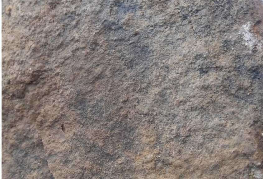
Fot. 9. Widok makroskopowy powierzchni przełamu piaskowca. Widoczne są nieregularne plamy o czarnej i ciemnobrązowej barwie. (Fot. M. Rembiś)
