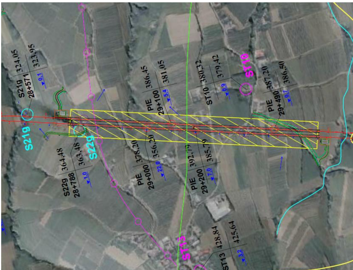
Rysunek 4 Wynikowa mapa hydrogeologiczna w rejonie tunelu T13.
