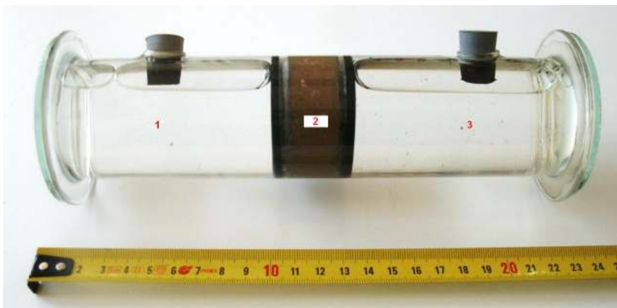
Rys. 15. Schemat badania procesu dyfuzji metodą „Steady-state”
