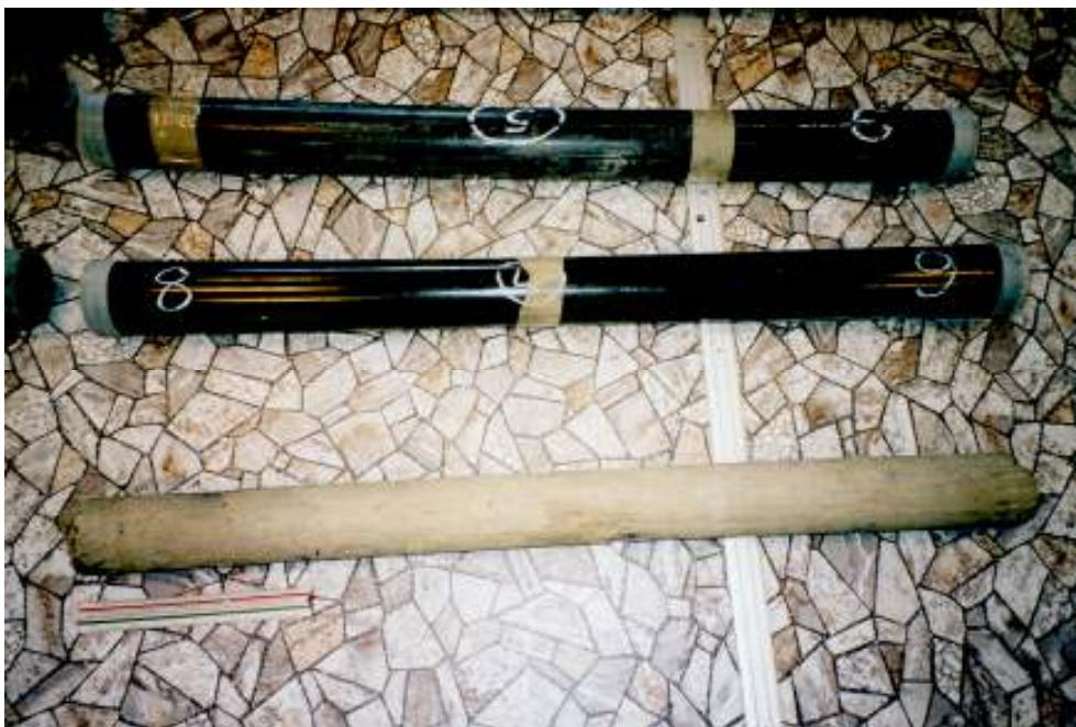
Fot. 4. Rdzenie o długości 1 m pobrane z uformowanej przesłony na poletku doświadczalnym do badań filtracji i badań dodatkowych
