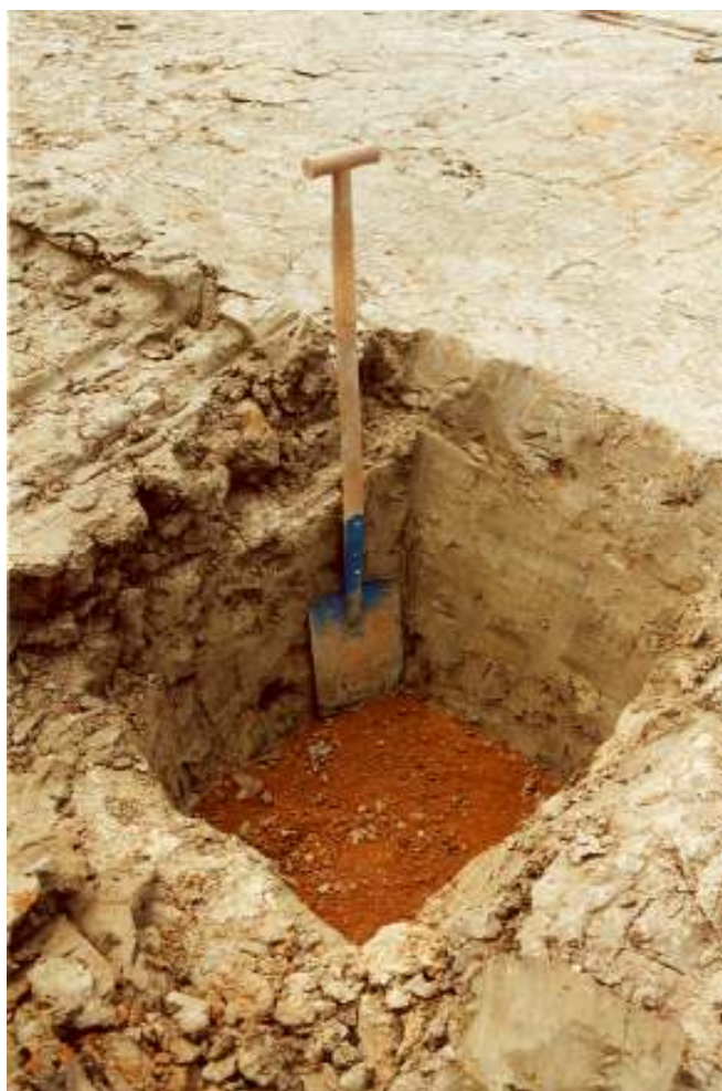
Fot. 3. Wykop wykonany w uformowanej przesłonie izolacyjnej na poletku doświadczalnym
