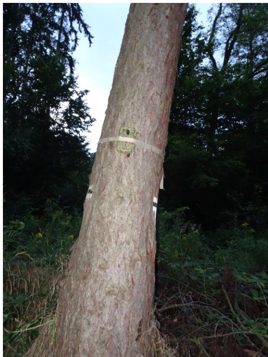
Zamontowany na drzewie detektor stacjonarny
