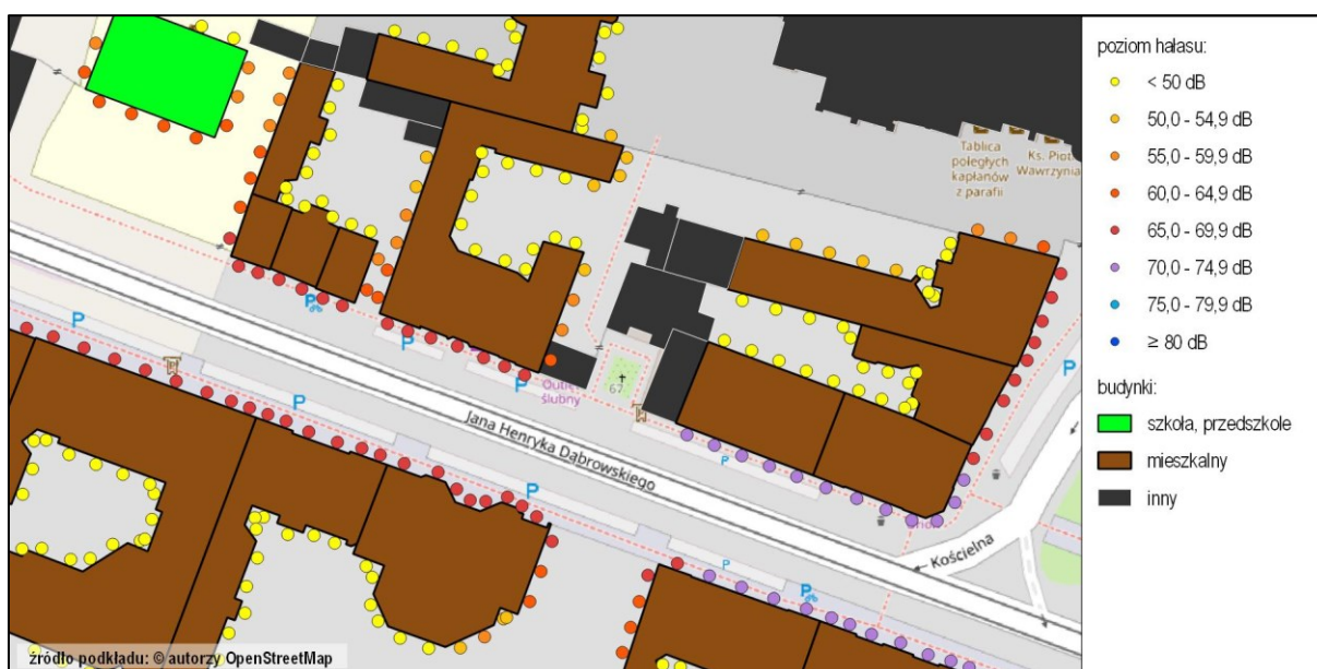
Rysunek 9 Wyniki obliczeń w siatce punktów obliczeniowych na elewacjach budynków mieszkalnych
