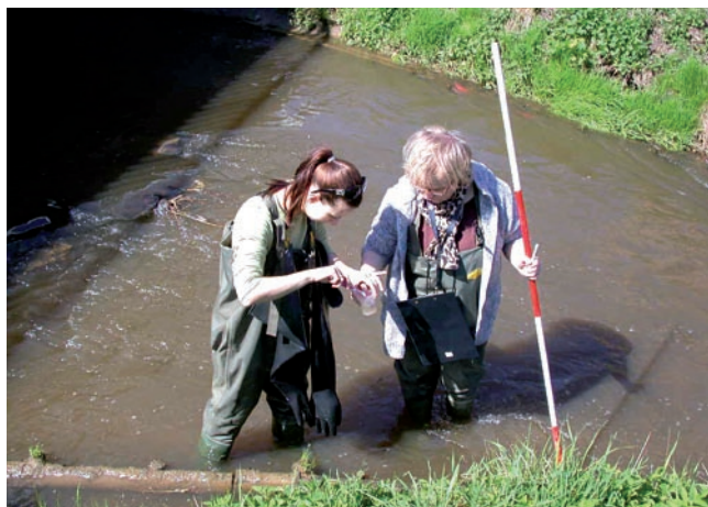
Fot. 3. Pobieranie próbek fitobentosu na rzece Sumina
