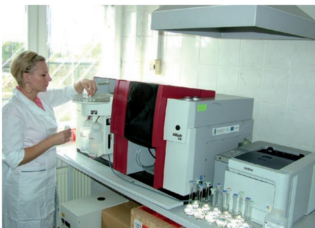
Fot. 1. Spektrofotometr ZEEenith 700P
