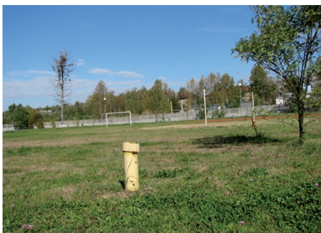
Fot. 2. Piezometr PT-2A - punkt monitoringu badawczego trichloroetenu i tetrachloroetenu w powiecie tarnogórskim
