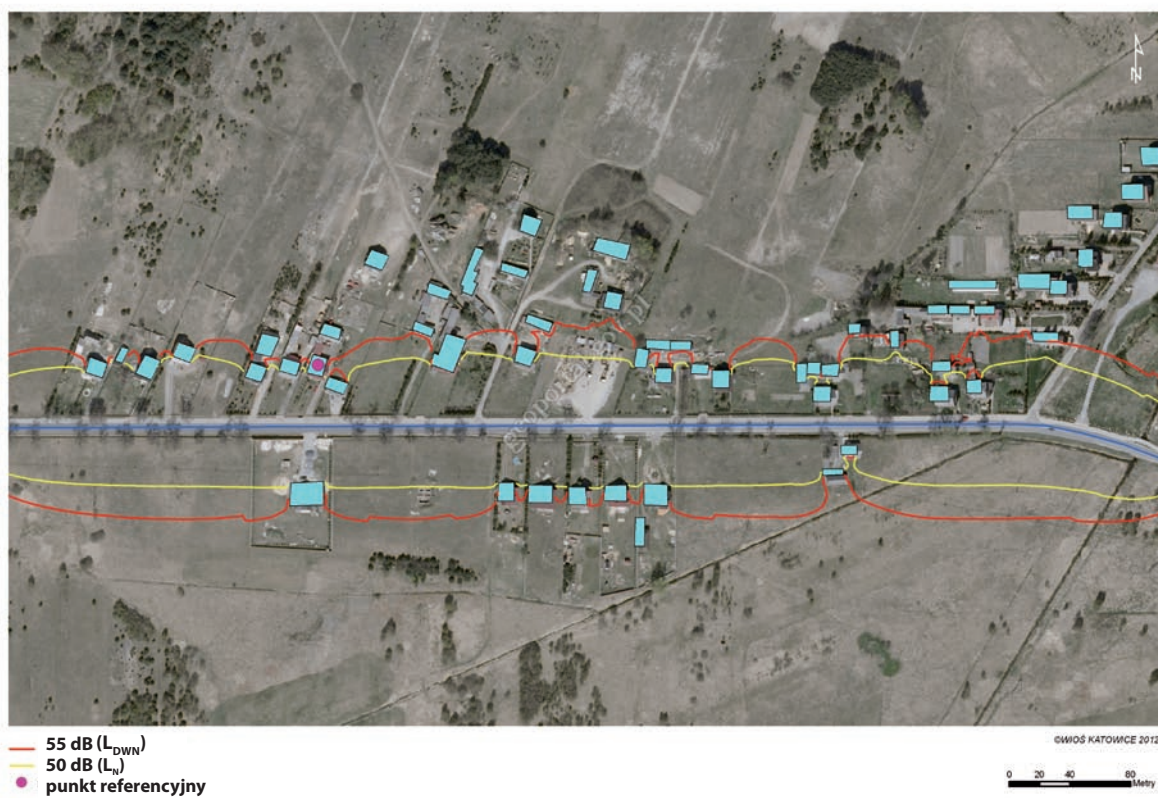
Mapa 5. Fragment mapy akustycznej dla wskaźnika oceny hałasu L_{DWN} oraz wskaźnika L_N w rejonie badań RB2 – ul. 22 Lipca, Kroczyce 2011 rok
