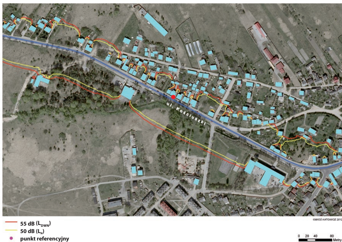
Mapa 4. Fragment mapy akustycznej dla wskaźnika oceny hałasu L_{DWN} oraz wskaźnika L_N w rejonie badań RB2 – ul. Kościuszki, Ogrodzieniec, 2011 rok
