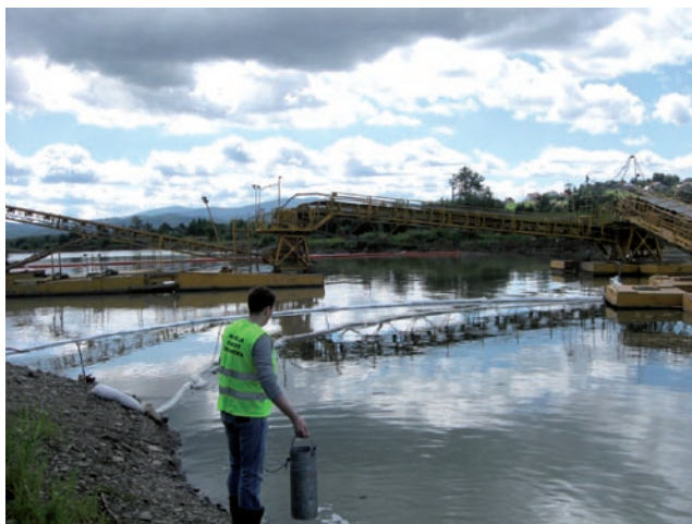
Fot. 1. Pomiar jakości wody w zbiorniku Żywieckim w związku z zanieczyszczeniem pogłębiarki
