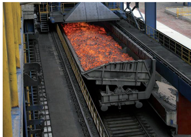
Fot. 2. Wóz gaszenia z gorącym koksem oraz wóz przelotowy z kapturem odpylającym w Koksowni „Radlin”
