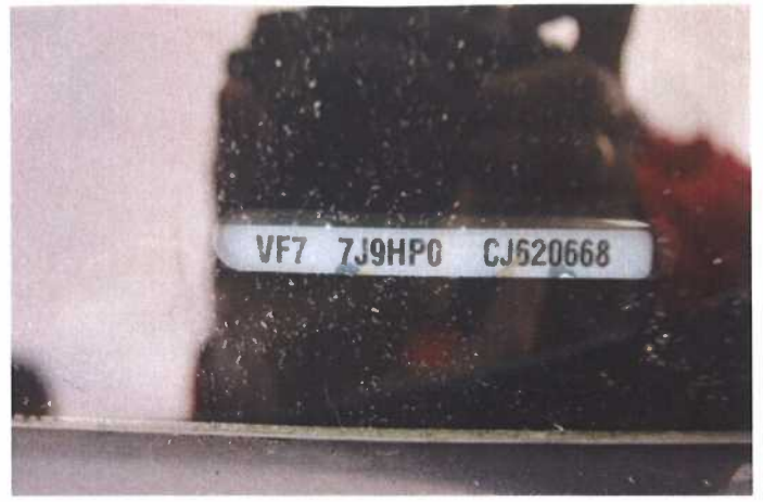
Fot. 10 Widok pola numerowego VIN na podszybiu
