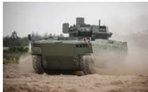
BORSUK składa się z podwozia – uniwersalnej modułowej platformy gaśnicowej oraz zdalnie sterowanego systemu wieżowego ZSSW-30
