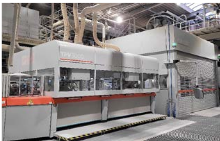
■ Urządzenie do cięcia TPV3000 oraz prasa PCR3000 jako centralne elementy linii produkcyjnej do produkcji płyt wielkoformatowych
