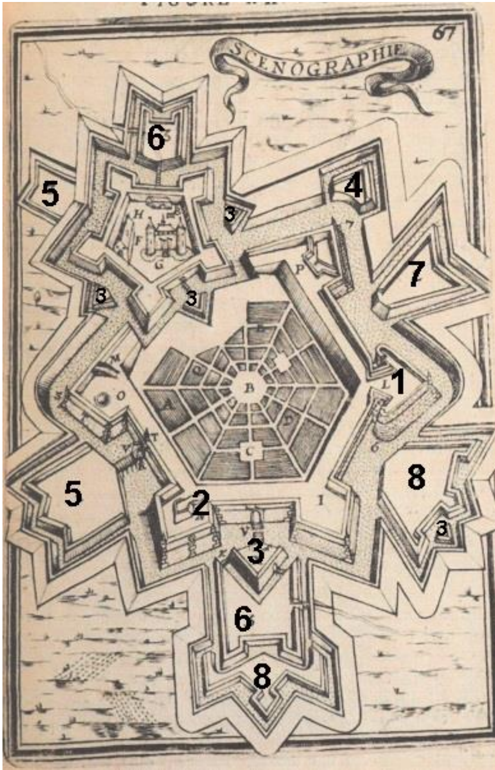
3.1. 1. Bastion z orylonami al orione , 2. Nadszaniec, 3. Raweliny, 4. Półksiężyc, 5. Dzieło rogowe kleszczowe, 6. Dzieło rogowe półbastionowe, 7. Jaskółczy ogon, 8. Dzieła koronowe. Rysunek z: A.M.Mallet, Les Travaux de Mars , 1685.
