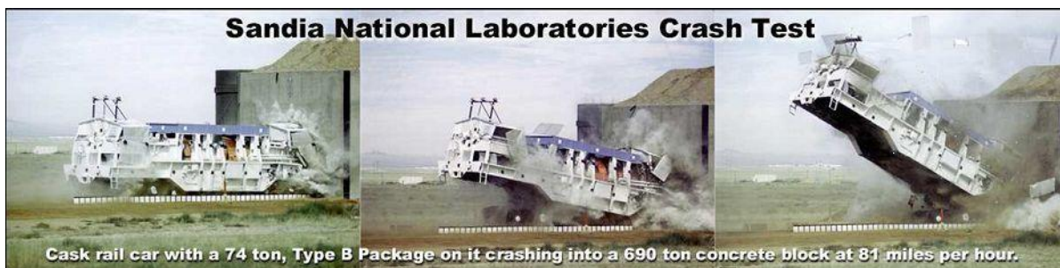
Rysunek 118. Wagon kolejowy z pojemnikiem typu B o wadze 74 ton uderza z prędkością 130 km/h w blok betonowy o wadze 690 ton. Zdjęcia z testów wykonanych przez Sandia National Laboratories cytowane za zezwoleniem Nuclear Energy Institute (USA).
